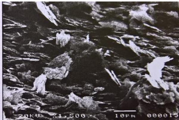
Slika 1. SEM snimke Wolstenholme Super 8000 Al praha, a) snimana odozgora, b) bočna snimka praha [2].
