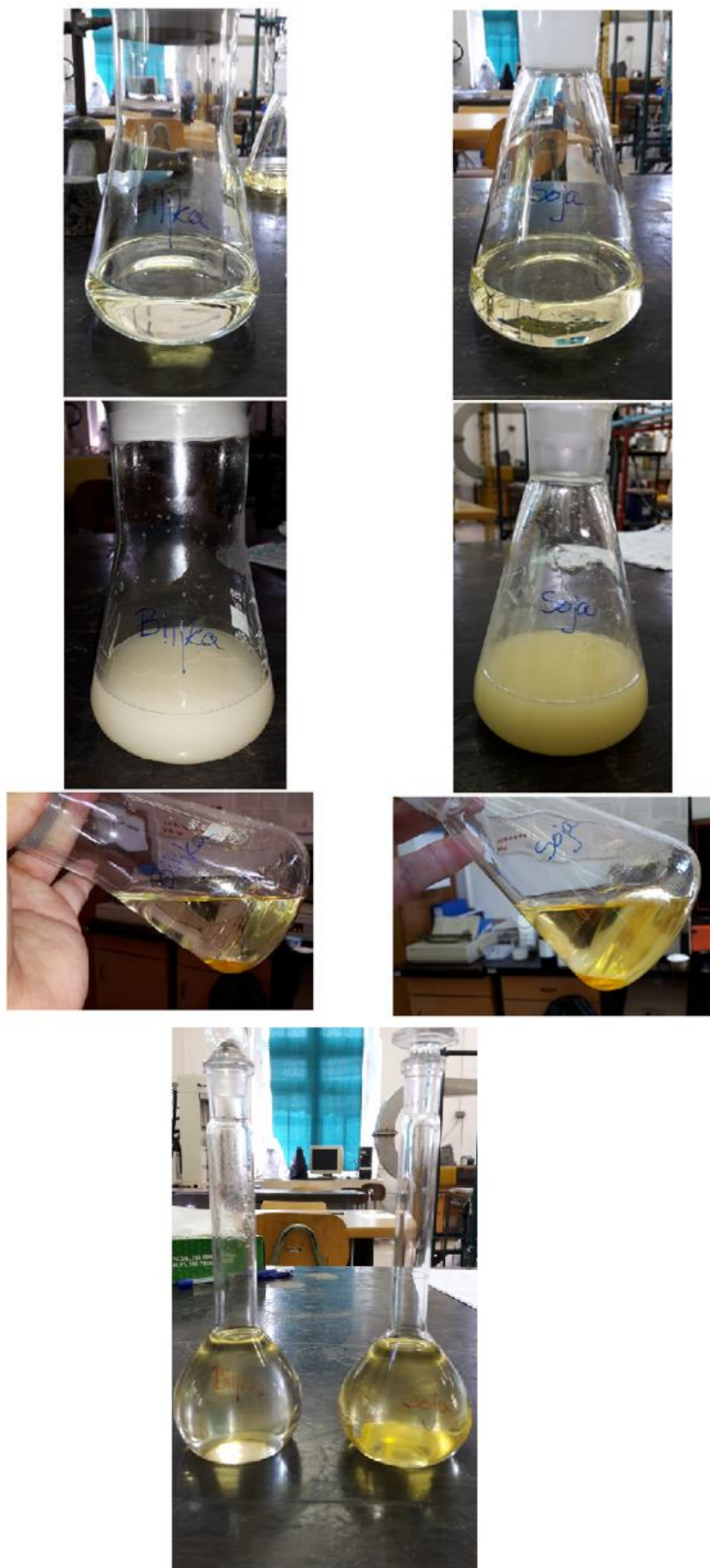
Slika 3.3. Priprava biodizela u koracima; Biljni biodizel lijevo, Sojin biodizel desno
