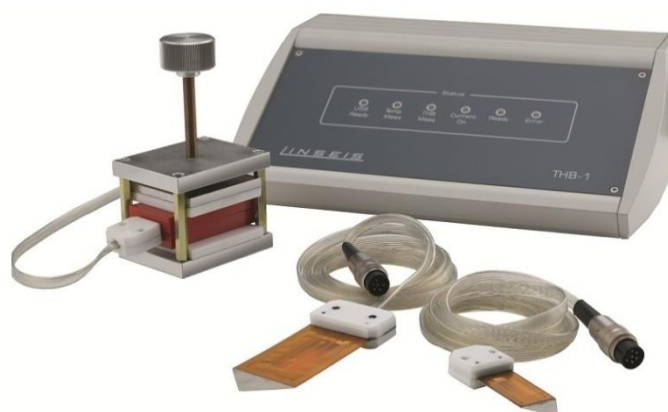
Slika 3.7. Uređaj za određivanje koeficijenta toplinske vodljivosti - Transient hot bridge 1
