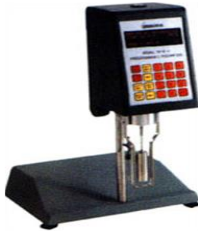
Slika 3.6. Rotacijski viskozimetar Brookfield DV – III ULTRA
