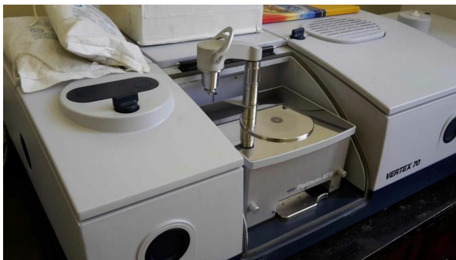
Slika 3.9. Uređaj za FTIR analizu- Bruker Vertex 70
