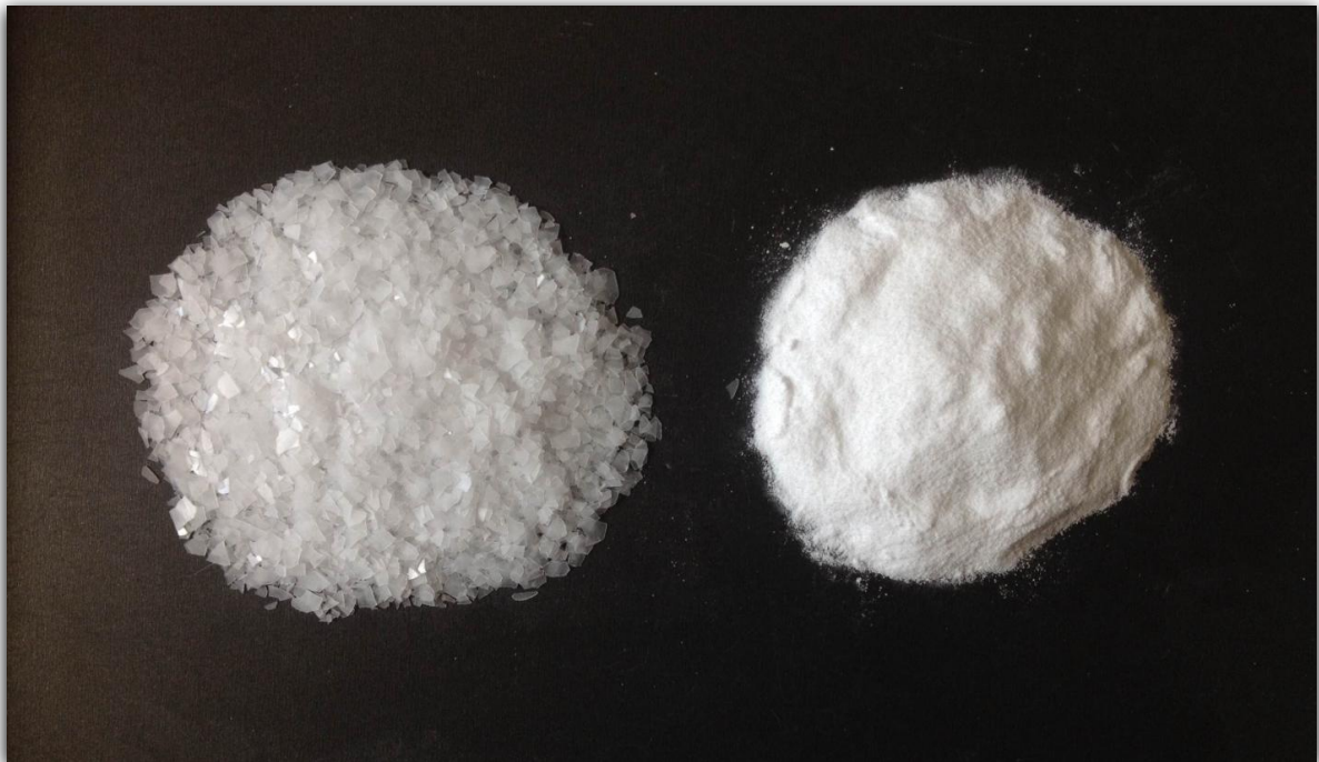
Slika 3.5. Usporedni prikaz inicijalnog (lijevo) i usitnjenog (desno) polietilen glikola.
