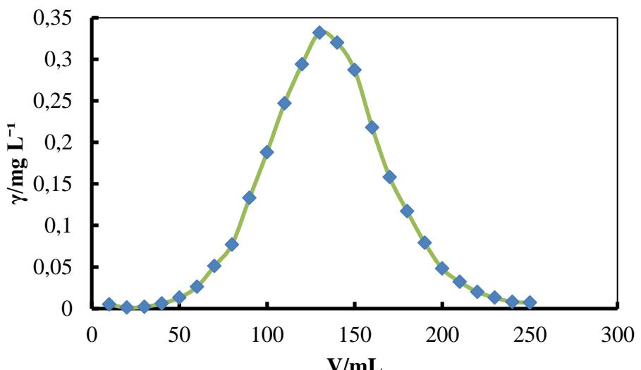
**Slika 22.** Krivulja eluiranja stroncija iz otopine  $0,25 \text{ mol L}^{-1} \text{ HNO}_3$  u metanolu kroz kolonu punjenu izmjenjivačem Serdolit<sup>TM</sup> CG-400 I ( $\text{NO}_3^-$  oblik); promjer kolone  $\phi = 1\text{cm}$ ; masa izmjenjivača  $m=4,00 \text{ g}$ ; visina stupca izmjenjivača  $h=13,5 \text{ cm}$ ; brzina protoka je  $1 \text{ mL/min}$
