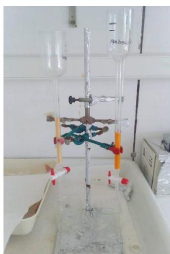
**Slika 17.** Lijevo na slici je kolona punjena anionskim izmjenjivačem Serdolit<sup>TM</sup> CG-400 I a desno je kolona punjena anionskim izmjenjivačem Amberlite CG-400
