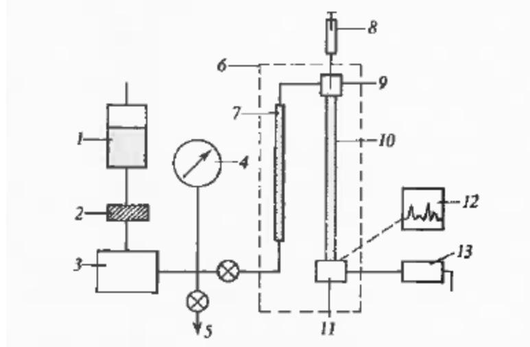
*Slika 5. Visokotlačni tekućinski kromatograf. 1 spremnik za pokretnu fazu, 2 filter, 3 visokotlačna pumpa, 4 manometar, 5 ispust, 6 termostat, 7 pretkolona, 8 uređaj za uvođenje uzorka, 9 injektor, 10 analitička kolona, 11 detektor, 12 pisalo, 13 kolektor frakcija*
