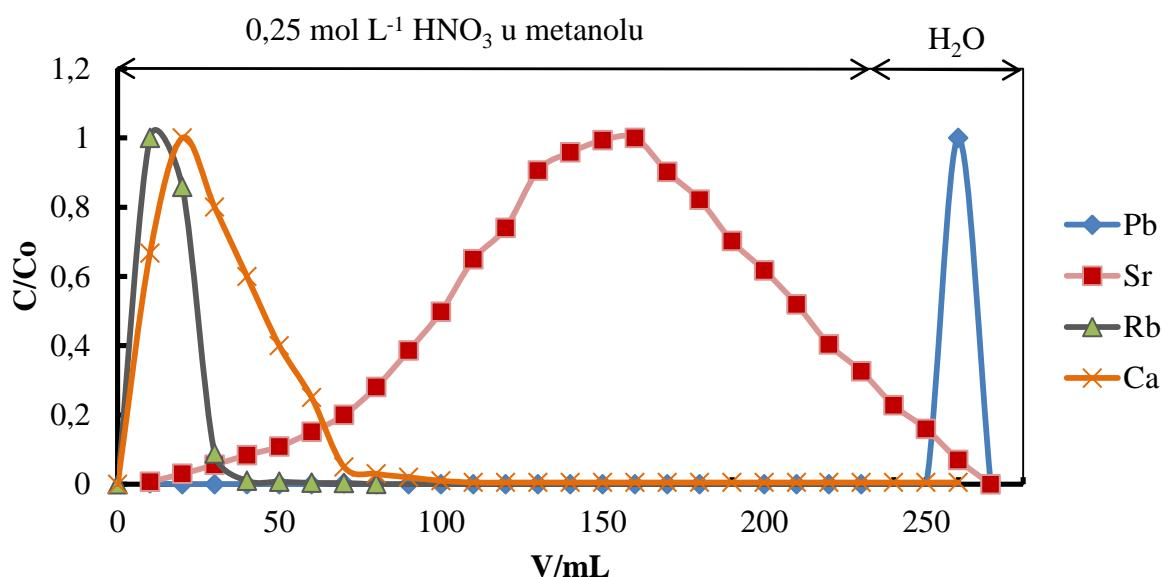
**Slika 24.** Odjeljivanje kalcija, stroncija, olova i rubidija na anionskom izmjenjivaču Amberlit CG-400 (NO<sub>3</sub><sup>-</sup> oblik); promjer kolone  $\phi=1\text{cm}$ ; masa izmjenjivača  $m=4,00\text{ g}$ ; visina stupca izmjenjivača  $h=11,5\text{ cm}$ ; brzina protoka je  $1\text{ mL/min}$
