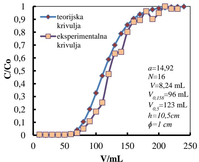
*Slika 19. Krivulja prodora stroncija iz  $0,25 \text{ mol L}^{-1}$  otopine  $\text{HNO}_3$  u metanolu na anionskom izmjenjivaču Amberlit CG-400 ( $\text{NO}_3^-$  oblik) dobivene eksperimentom i kompjutorskim proračunom*
