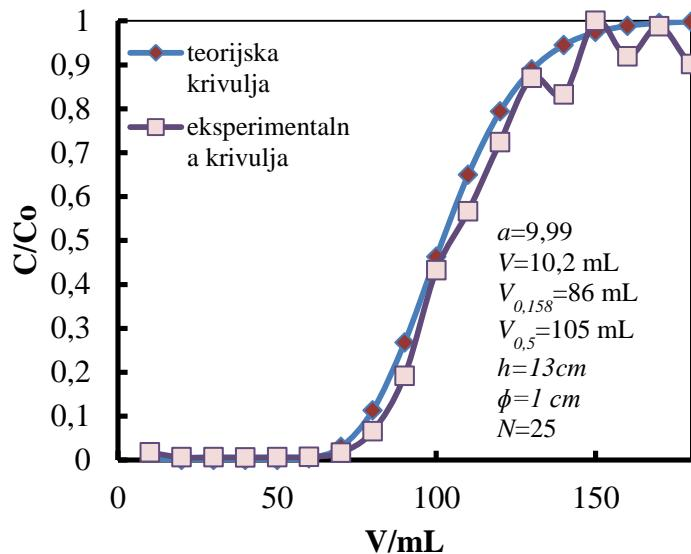
*Slika 20. Krivulja prodora stroncija iz  $0,25 \text{ mol L}^{-1}$  otopine  $\text{HNO}_3$  u metanolu na anionskom izmenjivaču Serdolit<sup>TM</sup> CG-400 I ( $\text{NO}_3^-$  oblik) dobivene eksperimentom i kompjutorskim proračunom*
