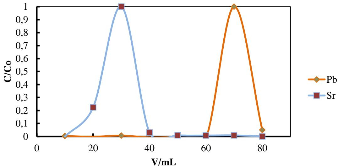
*Slika 25. Krivulja eluiranja stroncija iz otopine  $0,25 \text{ mol L}^{-1} \text{ HNO}_3$  u metanolu sa 20%  $\text{H}_2\text{O}$  kroz kolonu punjenu izmjenjivačem Amberlite CG-400 ( $\text{NO}_3^-$  oblik); promjer kolone  $\phi = 1\text{cm}$ ; masa izmjenjivača  $m=4,00 \text{ g}$ ; visina stupca izmjenjivača  $h=11,5 \text{ cm}$ ; brzina protoka je 1  $\text{mL/min}$*
