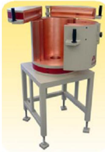
Slika 12. Štit gama detektora
