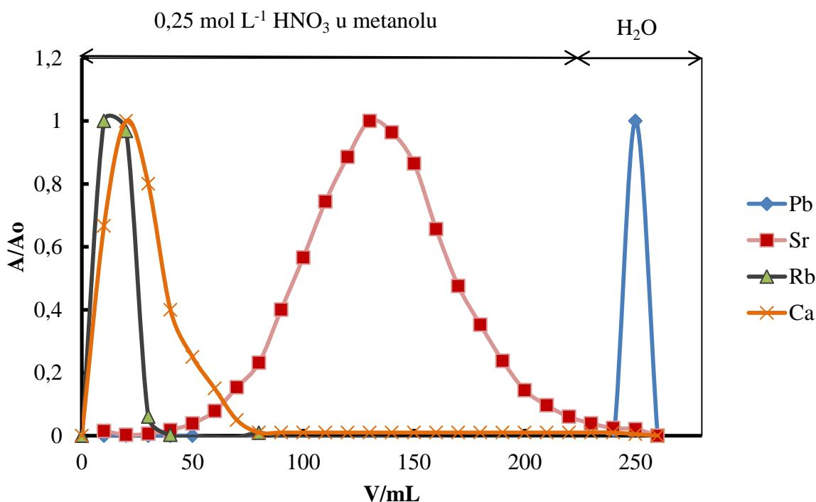
**Slika 23.** Odjeljivanje kalcija, stroncija, olova i rubidija na anionskom izmjenjivaču Serdolit<sup>TM</sup> CG-400 I (NO<sub>3</sub><sup>-</sup> oblik); promjer kolone  $\phi=1\text{cm}$ ; masa izmjenjivača  $m=4,00\text{ g}$ ; visina stupca izmjenjivača  $h=13,5\text{ cm}$ ; brzina protoka je  $1\text{ mL/min}$ ,
