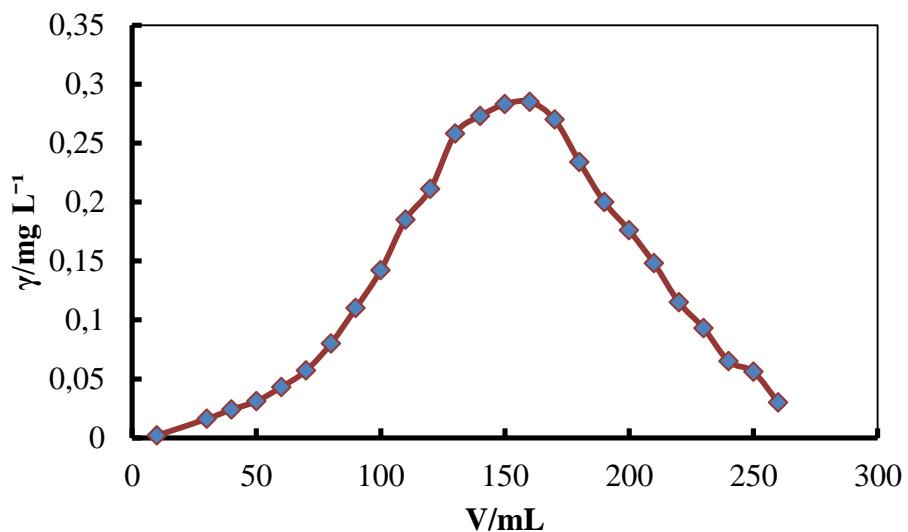
*Slika 21. Krivulja eluiranja stroncija iz otopine  $0,25 \text{ mol L}^{-1}$   $\text{HNO}_3$  u metanolu kroz kolonu punjenu izmenjivačem Amberlite CG-400 ( $\text{NO}_3^-$  oblik); promjer kolone  $\phi = 1 \text{ cm}$ ; masa izmenjivača  $m = 4,00 \text{ g}$ ; visina stupca izmenjivača  $h = 11,5 \text{ cm}$ ; brzina protoka je  $1 \text{ mL/min}$*
