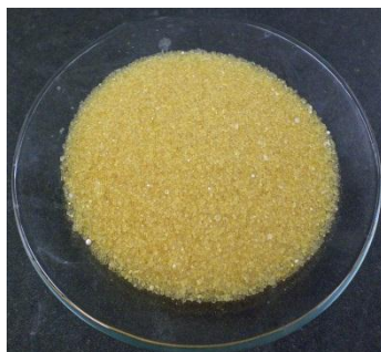
Slika 13. Anionski izmjenjivač Amberlite CG 400
