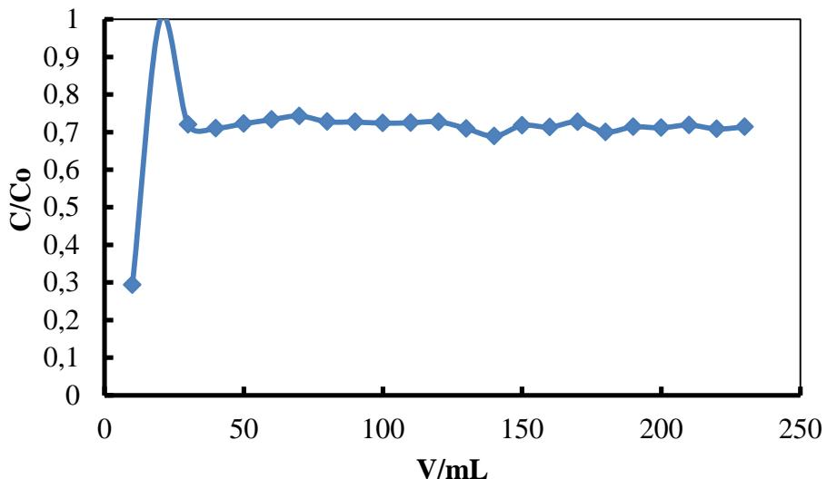
**Slika 18.** Krivulja prodora stroncija iz otopine  $1 \text{ mol L}^{-1}$   $\text{HCl}$  u metanolu kroz kolonu punjenu izmjenjivačem Amberlite CG-400 ( $\text{NO}_3^-$  oblik); promjer kolone  $\phi = 1\text{cm}$ ; masa izmjenjivača  $m=3,00\text{ g}$ ; visina stupca izmjenjivača  $l=8\text{ cm}$ ; brzina protoka je  $1\text{ mL/min}$ ;  $a=6,28$
