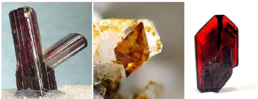
Slika 6. Polimorfne modifikacije TiO 2 (s lijeva na desno: rutil, anatas, brucit)
