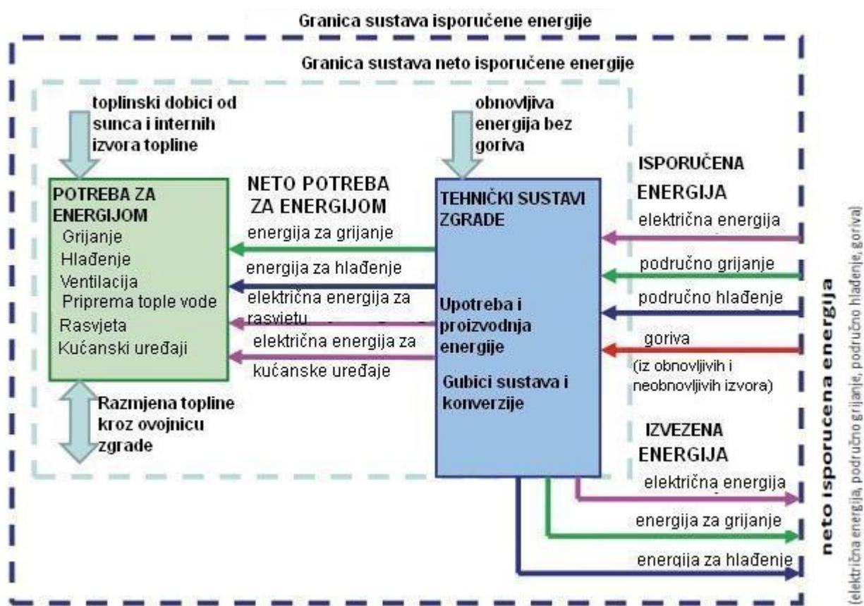
**Slika 3.** Energetska granica neto isporučene energije i način na koji se ona formira iz potrebe za energijom, potrošnje energije tehničkih sustava zgrade, proizvodnje energije iz obnovljivih izvora u krugu zgrade, isporučene i izvezene energije. Ćelija „Potreba za energijom“ odnosi se na prostorije unutar zgrade i granica sustava mogu se interpretirati kao granice zgrade [3].
