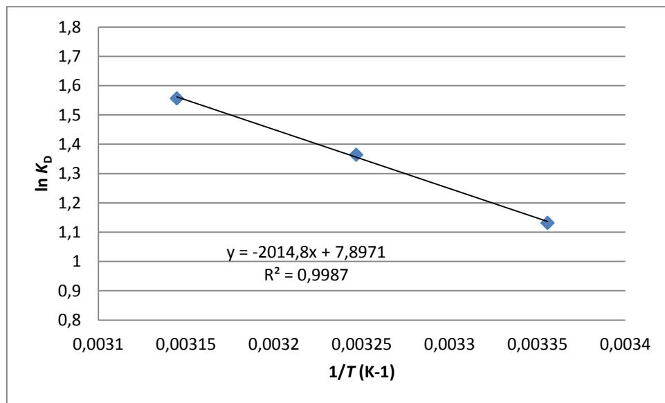
**Slika 27. Grafički prikaz  $\ln K_D$  u ovisnosti o  $1/T$  ( $K^{-1}$ ) za otopinu koncentracije 20 mg/L ( $V_{\text{otopine}}=15 \text{ mL}$ ,  $m_{\text{pepela}}=150 \text{ mg}$ )**
