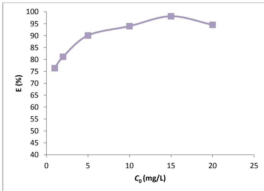
Slika 21. Učinkovitost uklanjanja enrofloksacina (%) kao funkcija početne koncentracije ( $V_{\text{otopine}}=15$  mL,  $m_{\text{pepele}}= 150$  mg)
