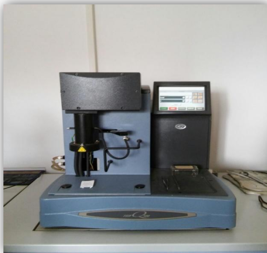
Slika 20. Termogravimetar, TA Instruments Q500
