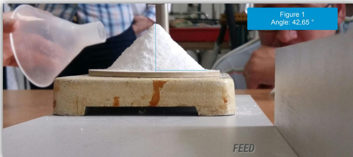
Slika 4.47. Fotografija formiranog stožaca za kolektiv GAS 34; primjena KLONK Image Measurement softverskog paketa u određivanju kutova mirovanja.
