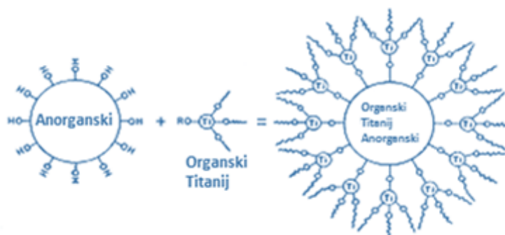
Slika 19. Shematski prikaz prevlačenja punila pomoću titanata
