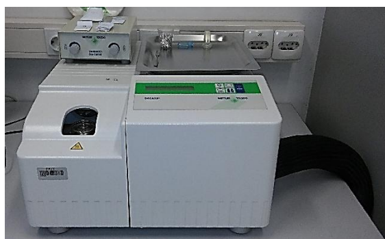
Slika 34. DSC uređaj Mettler Toledo DSC 823e
