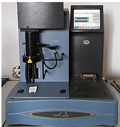
Slika 36. TGA uređaj TA Instruments Q500
