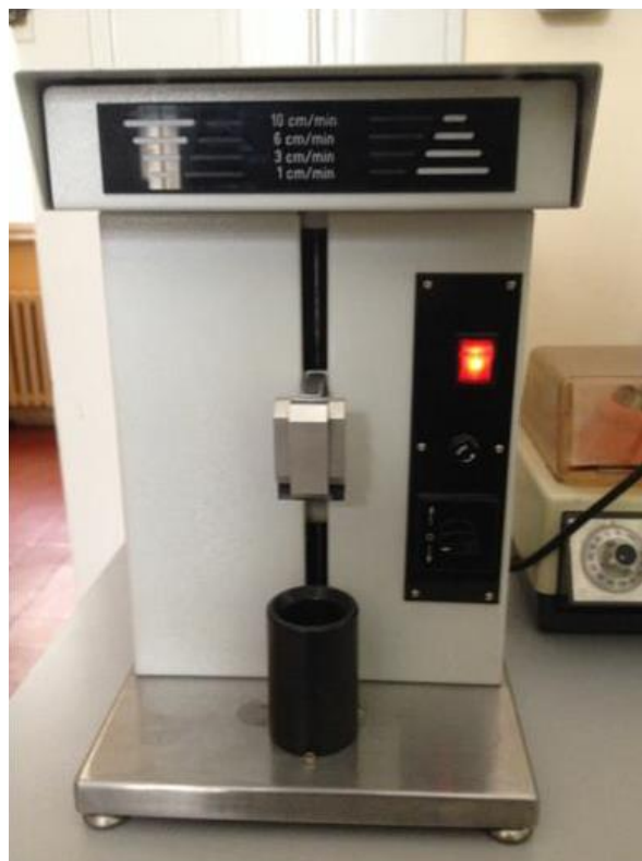
Slika 7.: Uređaj za nanošenje sola na pločice postupkom uranjanja
