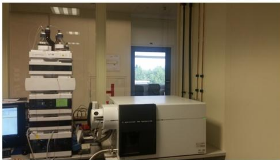
Slika 3.4 Tekućinski kromatograf UHPLC Agilent Series 1290
