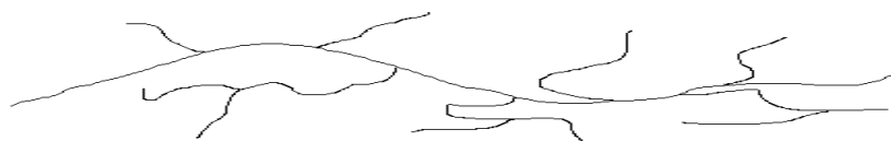
Slika 21. Razgranata struktura polietilena niske gustoće, PE-LD [15]
