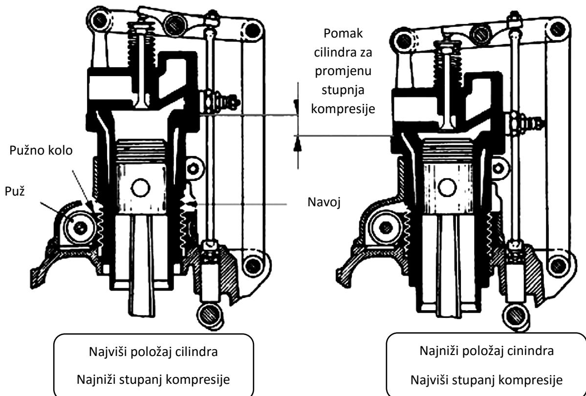
**Slika 2.** Motor za ispitivanje oktanskog broja
