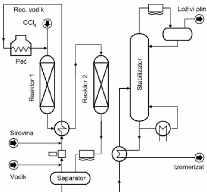
Slika 6. Shema BP (British Petroleum Co.) procesa  $\text{C}_5 - \text{C}_6$  izomerizacije
