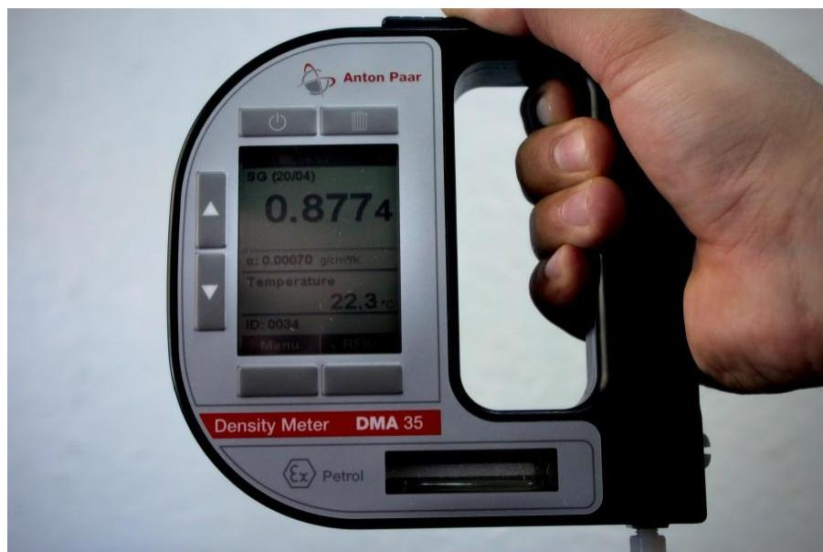
Slika 7. Korištena aparatura za mjerjenje gustoće
