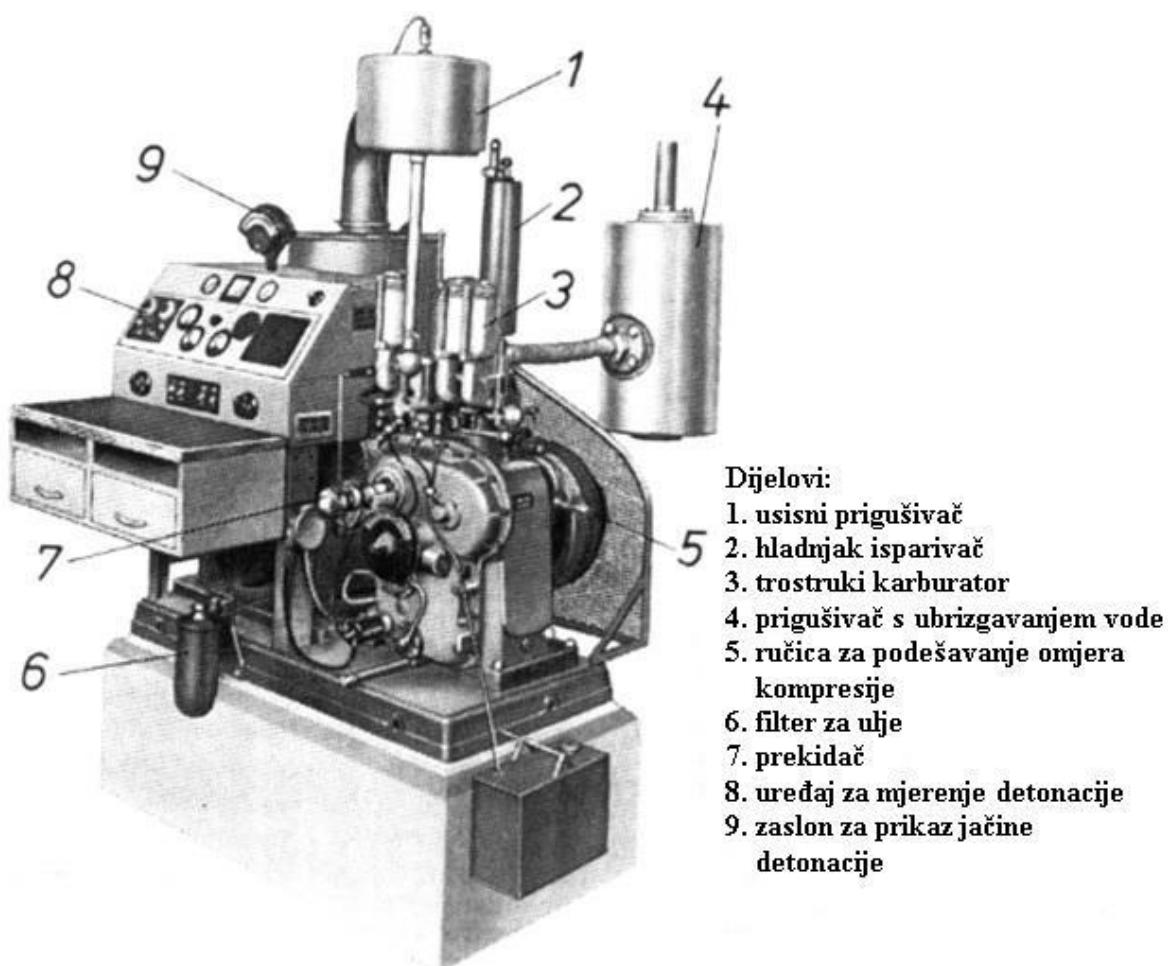
**Slika 3.** CFR motor za ispitivanje oktanskog broja
