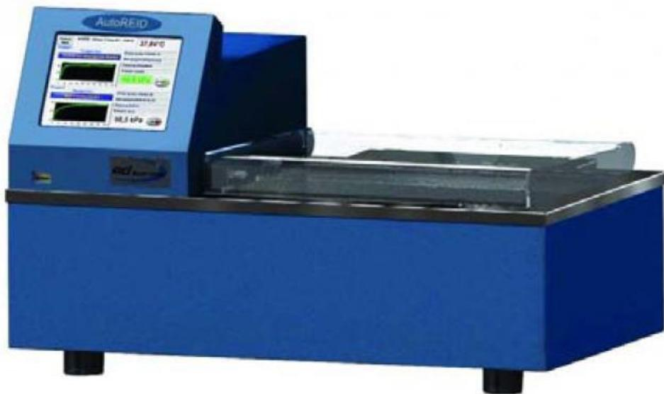
**Slika 8.** Uređaj za određivanje ukupnog tlaka para tekućih naftnih uzoraka
