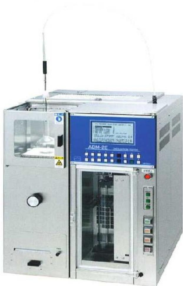
**Slika 10.** Korištena aparatura za destilaciju
