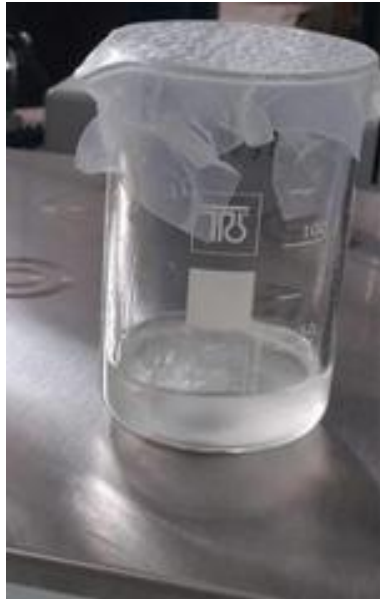
Slika 22. Otapanje NaOH u metanolu
