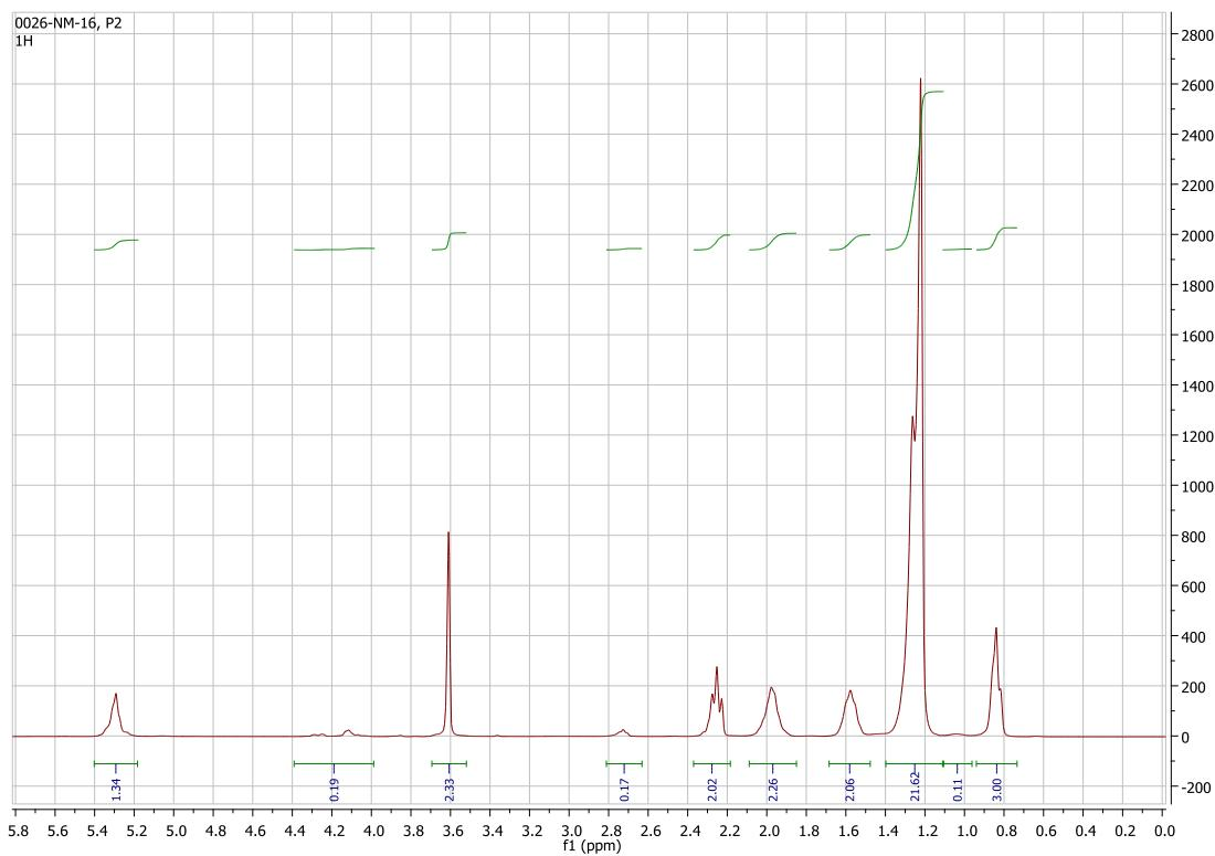
**Slika 44.** <sup>1</sup>H NMR spektar biodizela sintetiziranog iz pačje masti nakon ekstrakcije s ChClGly (76,90 % FAME)
