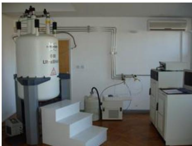
Slika 32. ^1\text{H} NMR Spektrometar Bruker Avance 300
