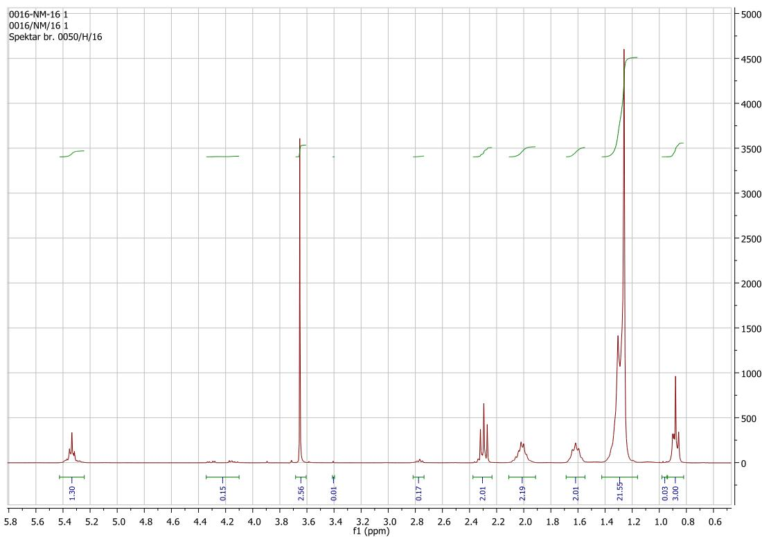
**Slika 39.**  $^1\text{H}$  NMR spektar biodizela sintetiziranog iz telećeg loja nakon ekstrakcije s ChClEG(85,57 % FAME)
