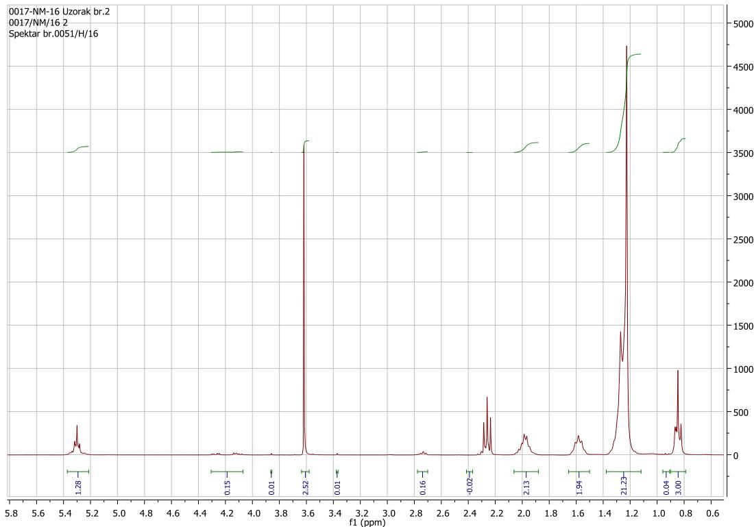
**Slika 40.**  $^1\text{H}$  NMR spektar biodizela sintetiziranog iz telećeg loja nakon ekstrakcije s ChClGly (87,50 % FAME)
