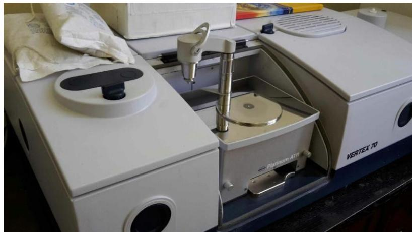
**Slika 31.**Uređaj za FTIR analizu- *Bruker Vertex 70*
