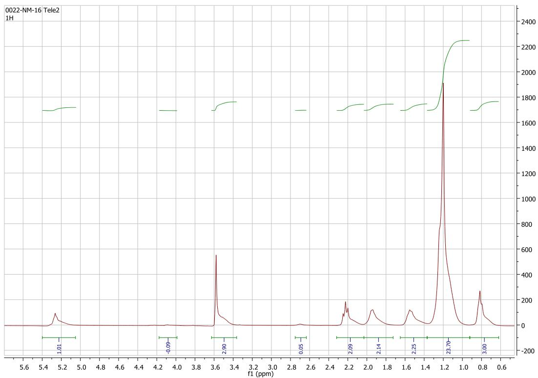
**Slika 46.**  $^1\text{H}$  NMR spektar biodizela sintetiziranog iz telećeg loja nakon ekstrakcije pri  $60\text{ }^\circ\text{C}$  s ChClMa30% $\text{H}_2\text{O}$  (92,50 % FAME)
