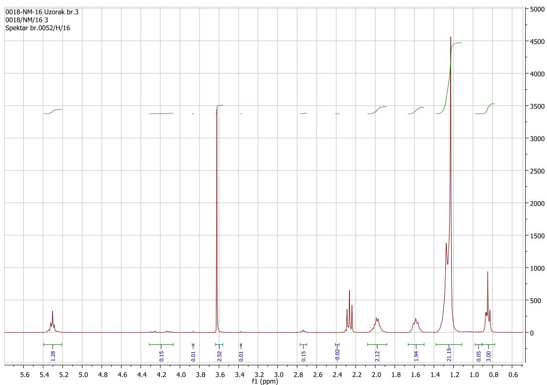
**Slika 41.**  $^1\text{H}$  NMR spektar biodizela sintetiziranog iz telećeg loja nakon ekstrakcije s ChClMa30% $\text{H}_2\text{O}$  (87,05 % FAME)
