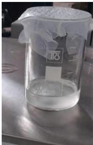
**Slika 22.** Otapanje NaOH u metanolu
