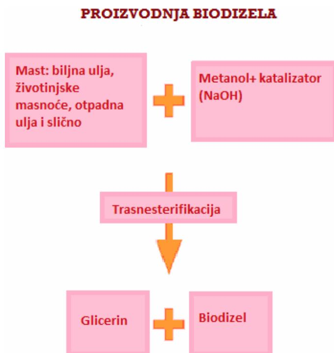
Slika 5. Proces proizvodnje biodizela
