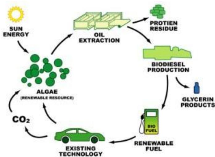
**Slika 9.**Prikaz kruženja CO<sub>2</sub> pri proizvodnji i primjeni biodizela
