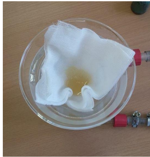
Slika 24. Uklanjanje glicerola filtracijom
