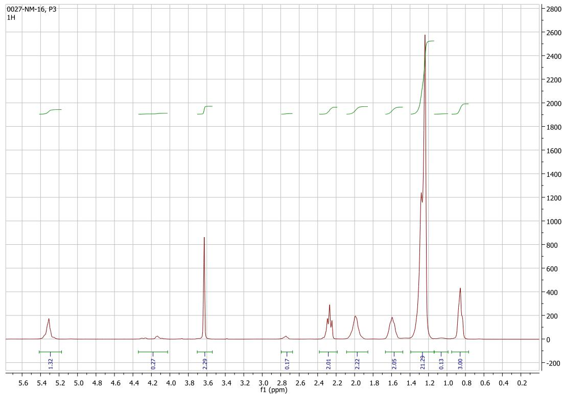
**Slika 45.** <sup>1</sup>H NMR spektar biodizela sintetiziranog iz pačje masti nakon ekstrakcije s ChClMa30%H<sub>2</sub>O (75,95 % FAME)
