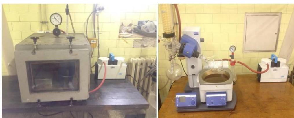
**Slika 19.** Vakuum sušionik i vakuum isparivač
