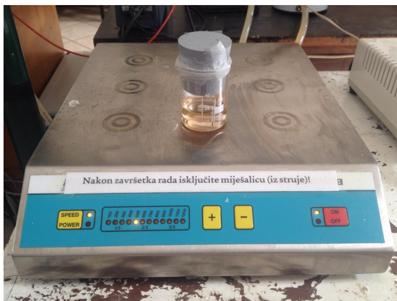
Slika 15. Šaržni ekstraktor s magnetskim miješanjem
