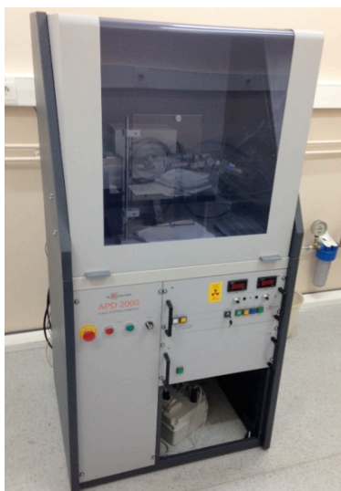
Slika 3.5. Difraktometar APD 2000 proizvođača Ital Structures®.
