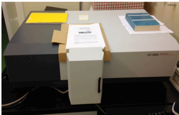
Slika 3.6. UV-3600 spektrometar proizvođača Shimadzu®.
