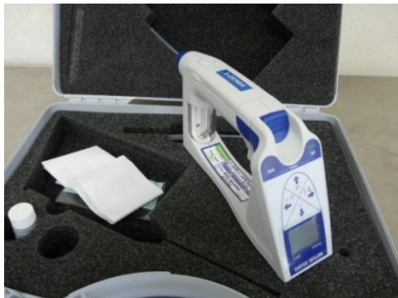
**Slika 21.** Densitometar *METTLER TOLEDO Densito 30PX*.
