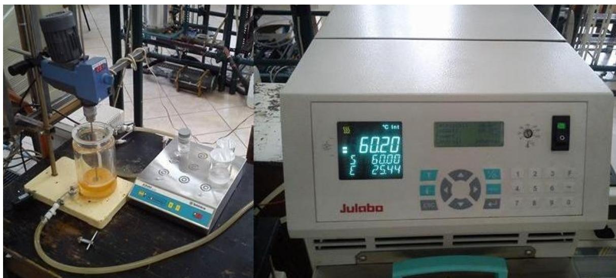
**Slika 15.** Aparatura za sintezu biodizela
