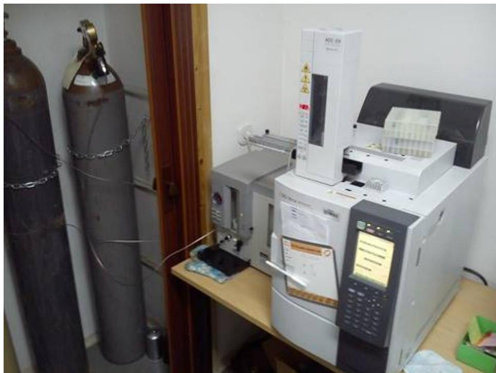
**Slika 22.** Plinski kromatograf Shimadzu GC-2014
