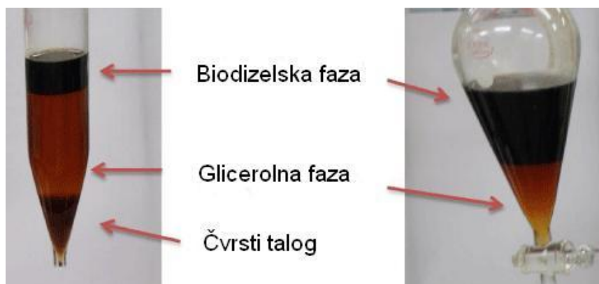
Slika 9. Biodizelska i glicerolna faza nakon odjeljivanja.
