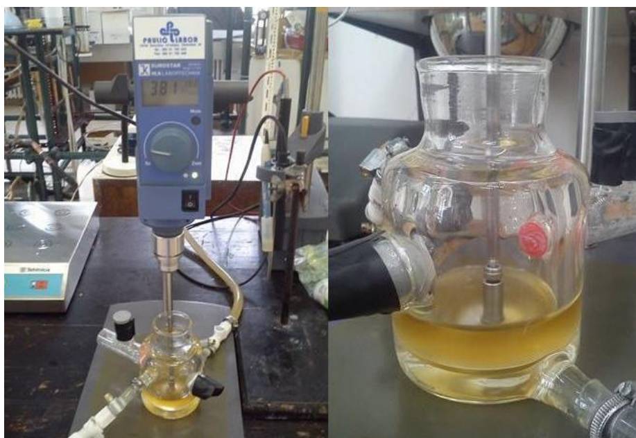
Slika 19. Ekstrakcija zaostalog glicerola iz biodizela pomoću eutektičkog otapala.
