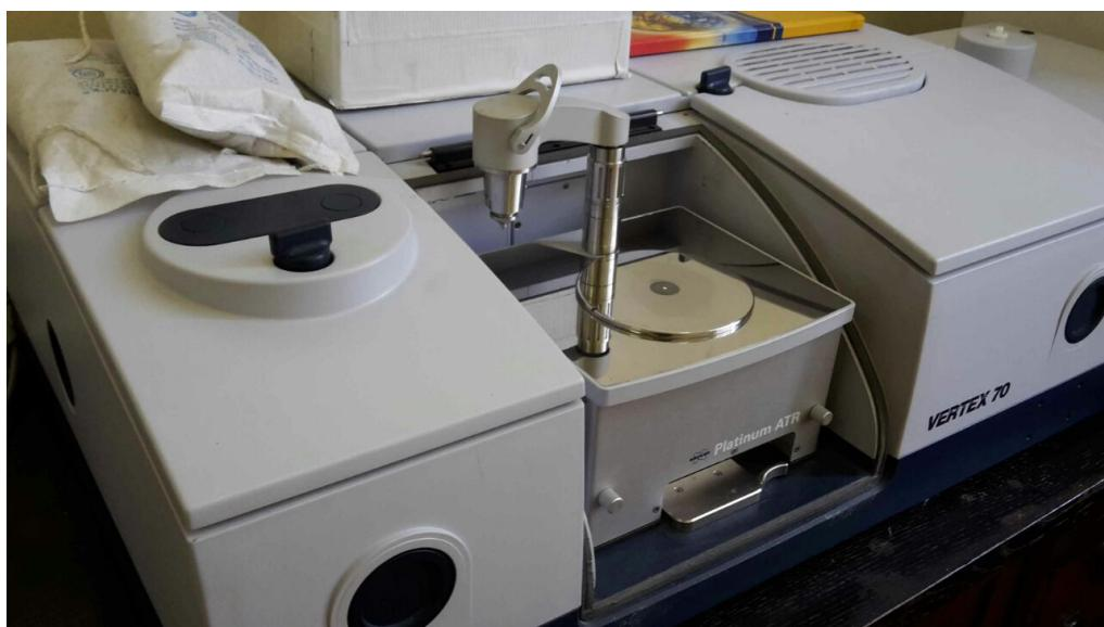
**Slika 23.** Uređaj za FTIR - Bruker Vertex 70
