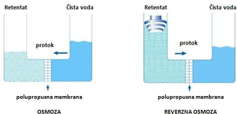
Slika 2.2 Shematski prikaz procesa osmoze i reverzne osmoze
