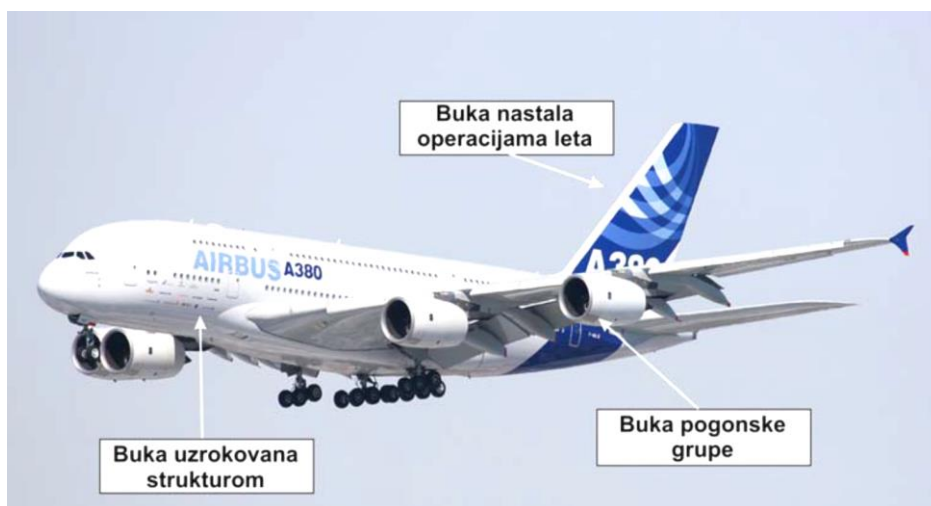
Slika 23. Izvori buke na zrakoplovu.
