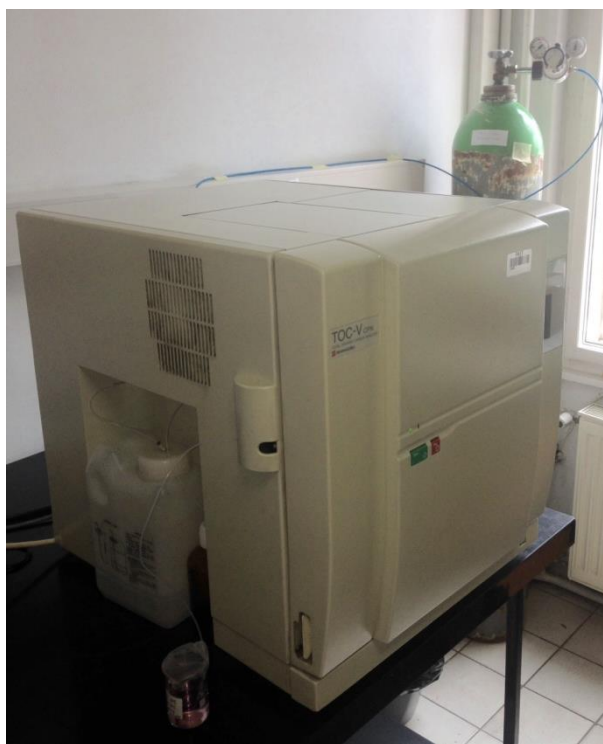
Slika 12. Analizator ukupnog organskog ugljika Shimadzu TOC-V
