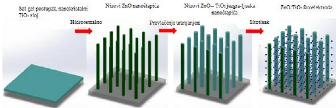
Slika 7. Shematski prikaz procesa sinteze ZnO/TiO<sub>2</sub> fotoelektrode<sup>13</sup>
