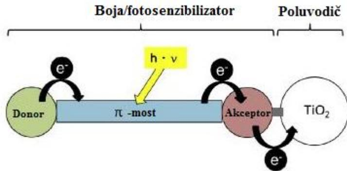
Slika 6. Građa boje kod bojom senzibilizirane solarne čelije s  $\text{TiO}_2$  fotoanodom<sup>6</sup>
