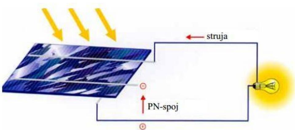
Slika 2. Solarna čelija kao izvor električne energije<sup>2</sup>
