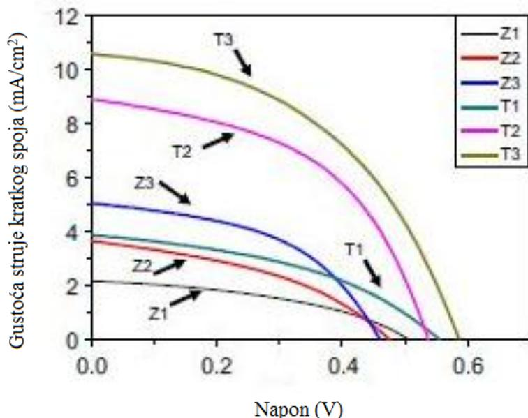
Slika 10. Eksperimentalno dobivena I-V krivulja uzoraka DSSC na osnovi nanočestične (NP) ZnO fotoanode (Z1 – Z3) i na osnovi ZnO/TiO<sub>2</sub> nanokompozitne (NC) fotoanode (T1 – T3)<sup>14</sup>
