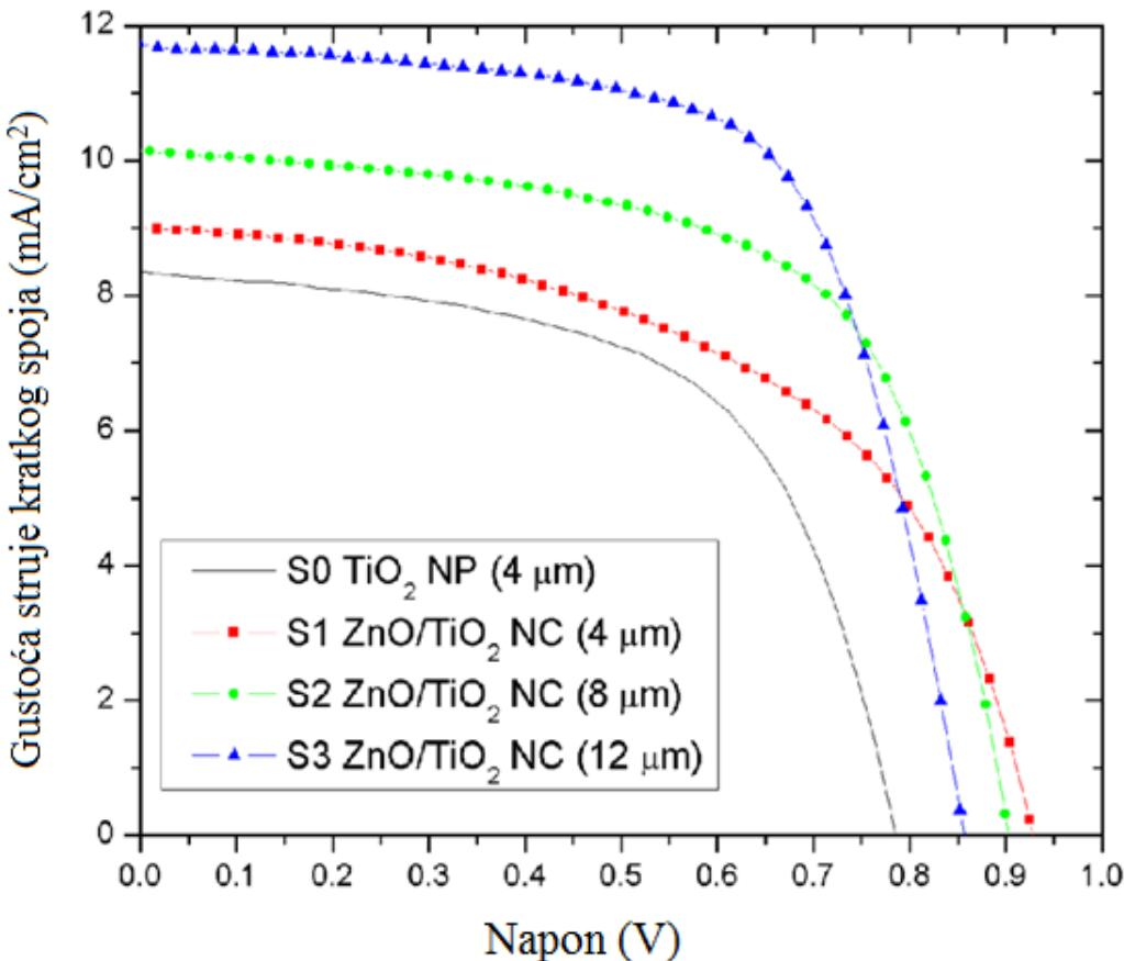
Slika 9. Eksperimentalno dobivena I-V krivulja uzorka DSSC na osnovi ZnO/TiO<sub>2</sub> nanokompozitne (NC) fotoanode i na osnovi nanočestične (NP) TiO<sub>2</sub> fotoanode<sup>13</sup>
