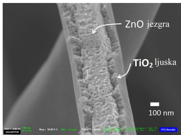
Slika 8. Fotografija ZnO-TiO<sub>2</sub> jezgra-ljuska nanoštapića dobivena pretražnim elektronskim mikroskopom<sup>13</sup>
