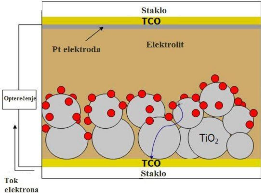
Slika 4. Shematski prikaz bojom senzibilizirane solarne čelije na osnovi  $\text{TiO}_2$ , crveno označene molekule boje, TCO – prozirni vodljivi oksid<sup>5</sup>
