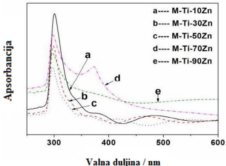
Slika 11. Apsorpcijski spektar ultraljubičastog i vidljivog zračenja za nanokompozitni sloj  $\text{ZnO}/\text{TiO}_2$  s udjelima  $\text{Zn}^{2+}$  od 10, 30, 50, 70 i 90 %<sup>15</sup>
