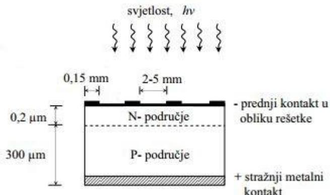
Slika 1. Silicijeva solarna čelija,  $h$  – Planckova konstanta,  $v$  – frekvencija promatranoga elektromagnetskog zračenja<sup>2</sup>
