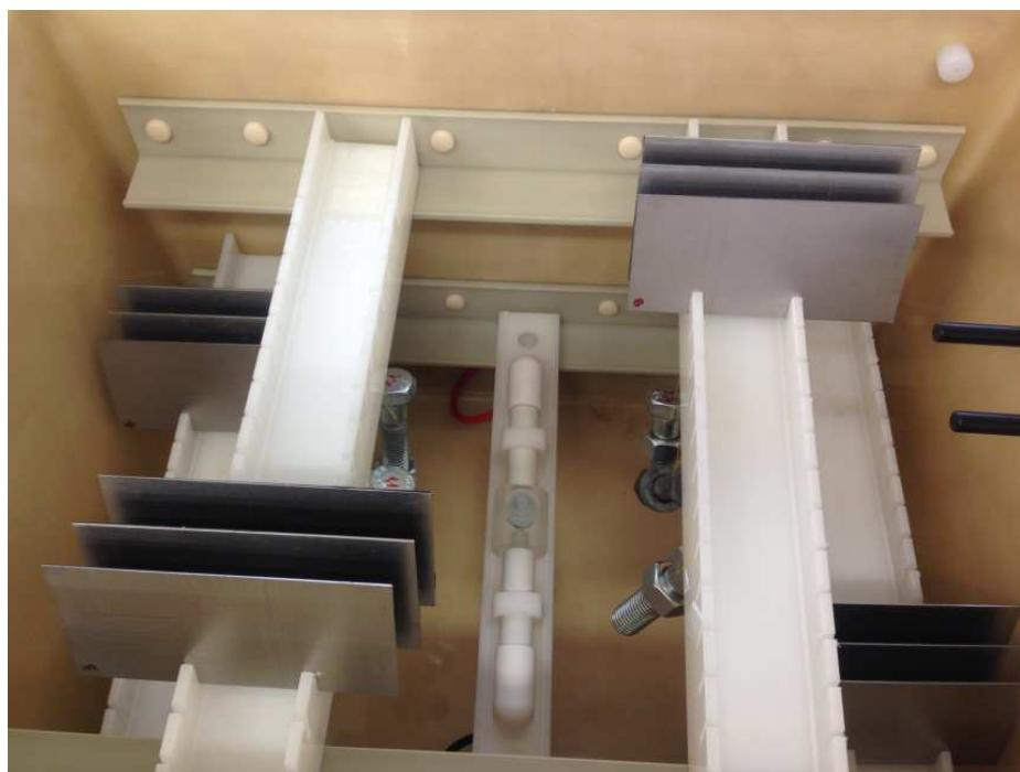
Slika 2. Raspored nepoliranih uzoraka u slanoj komori
