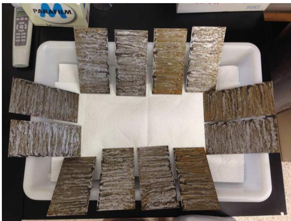
Slika 8. Nepolirani uzorci nakon mehaničkog čišćenja
