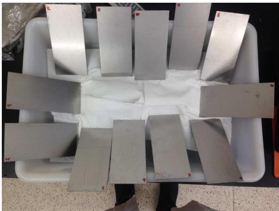
Slika 5. Očišćeni nepolirani uzorci spremni za testiranje
