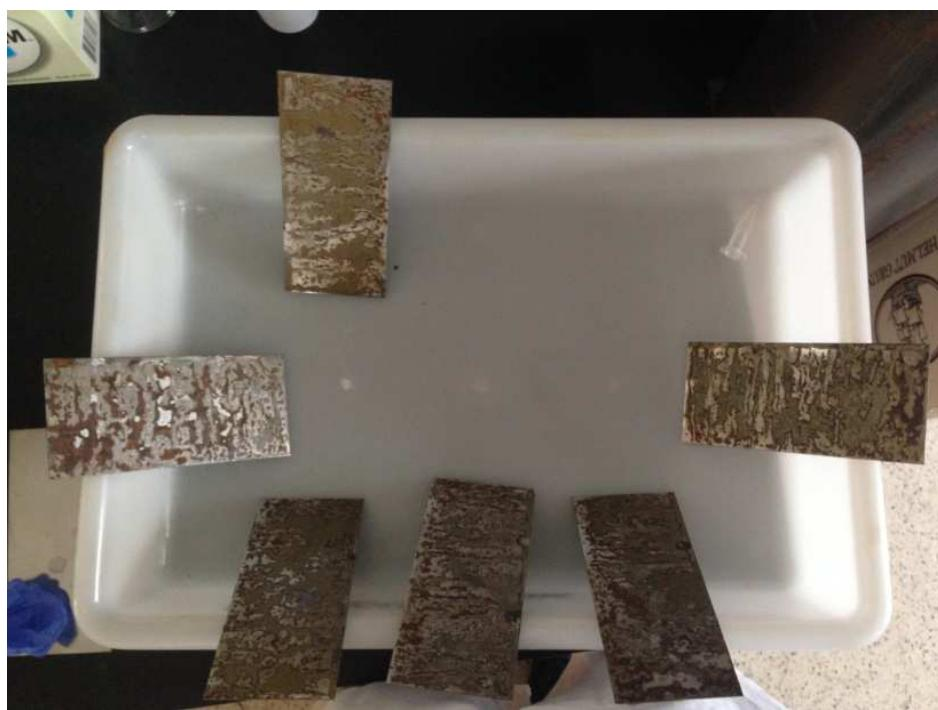
Slika 9. Polirani uzorci nakon mehaničkog čišćenja
