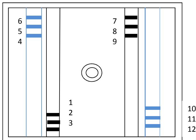
Slika 10. Tlocrt slane komore s nepoliranim uzorcima
