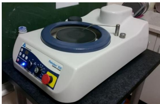
Slika 11. Uređaj za poliranje Buehler Meta Serv 250 Grinder - Polisher
