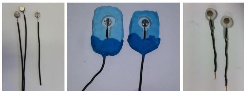
Slika 10. Priprema radnih elektroda
