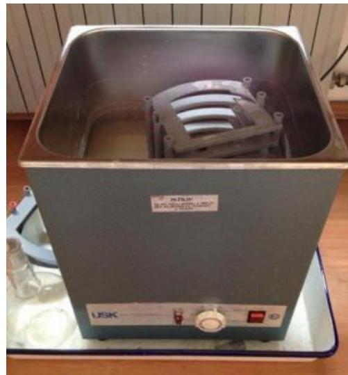
**Slika 12.** Ultrazvučna kupelj
