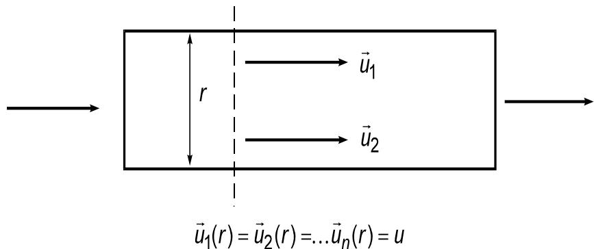
Slika 2.1. Prikaz idealnog strujanja u cijevnom reaktoru
