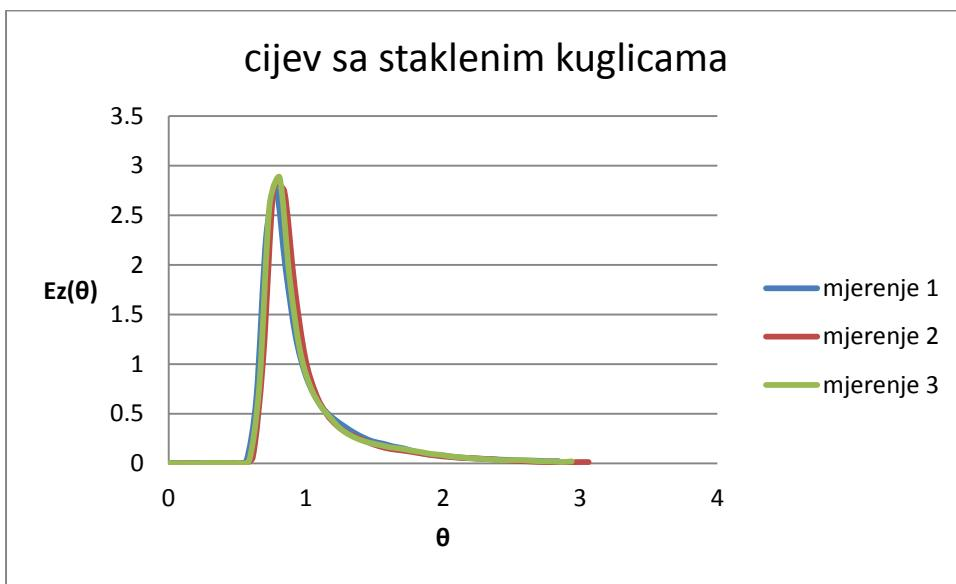
Slika 4.1. Usporedba  $E_z(\theta)$  funkcija za tri različita mjerjenje pri istim uvjetima volumena 0,5 mL i protoka 3,5 na rotometru (213 mL/min) u cijevi sa staklenim kuglicama
