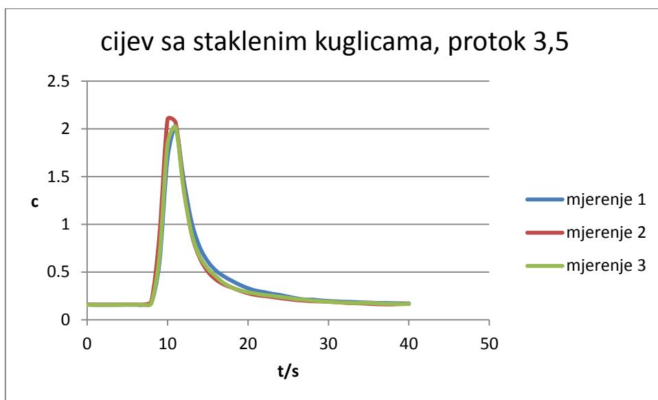
Slika 3.5. Provedba eksperimenta tri puta pri istim uvjetima volumena 0,5 mL i protoka 3,5 na rotometru (213 mL/min) u cijevi sa staklenim kuglicama
