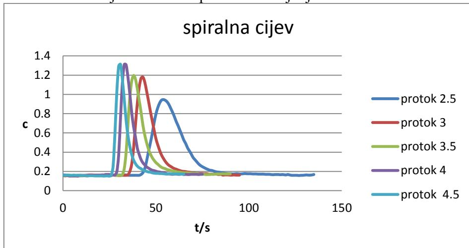
Slika 3.7. Promjena protoka u spiralnoj cijevi pri volumenu trasera 0,5 mL
