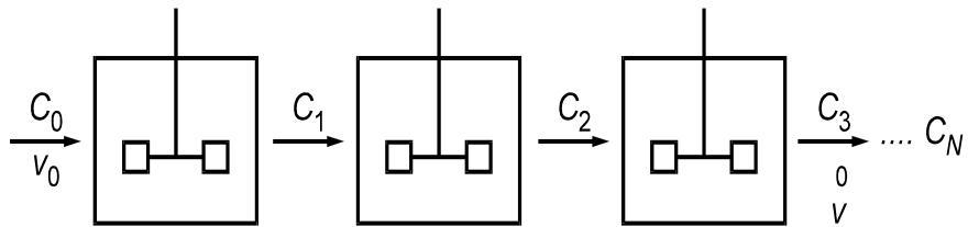
Slika 2.11. Strujanje prema modelu ćelija vezanih u seriju
