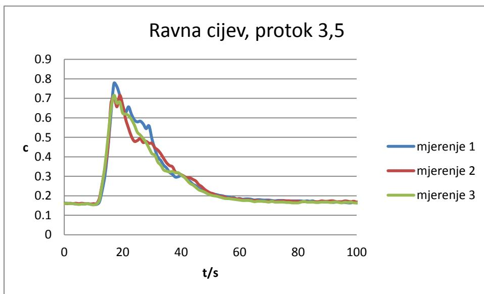
Slika 3.4. Provedba eksperimenta tri puta pri istim uvjetima volumena 0,5 mL i protoka 3,5 na rotometru (213 mL/min) u ravnoj cijevi
