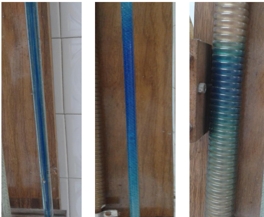
Slika 3.3. Strujanje obojenog traseru u a) ravnoj cijevi, b) ravnoj cijevi sa staklenim kuglicama, c) spiralnoj cijevi
