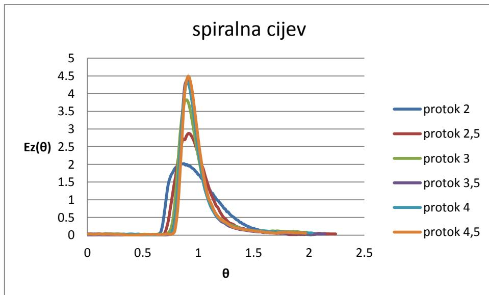
Slika 4.3. Usporedba  $E_z(\theta)$  funkcija pri različitim protocima u spiralnoj cijevi za volumen trasera 0,5 mL
