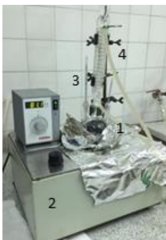
Slika 3.7. Aparatura za provođenje kemijske oksidacije alkohola koja se sastoji od: 1) tikvica, 2) vodena kupelj, 3) termometar, 4) Liebigovo hladilo
