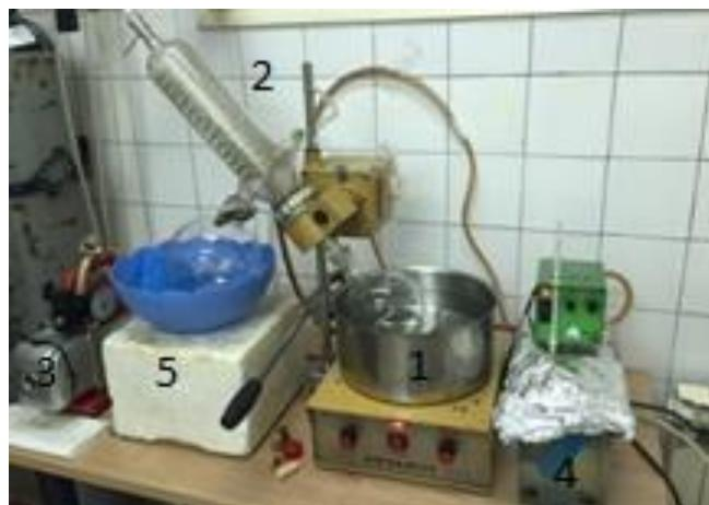
**Slika 3.8.** Aparatura za vakuum evaporaciju koja se sastoji od: 1) vodena kupelj s tirkicom, 2) sustav za hlađenje, 3) vakuum pumpa, 4) vodena kupelj niske temperature, 5) hladna vodena kupelj s tirkicom
