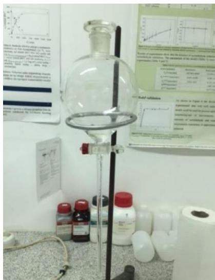
**Slika 3.12.** Lijevak za odjeljivanje
