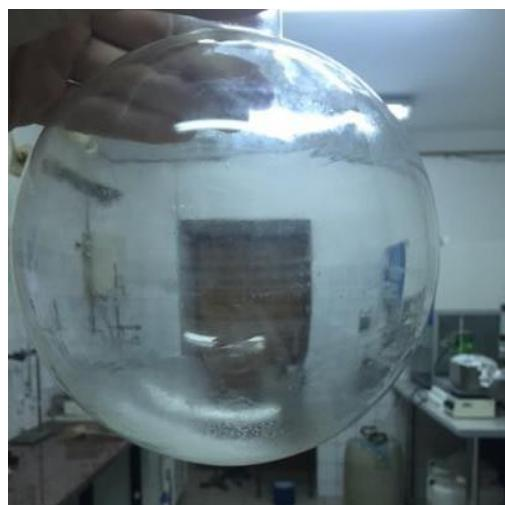
**Slika 4.7.** Kristalići zaštićene aminokiseline nakon vakuum evaporacije
