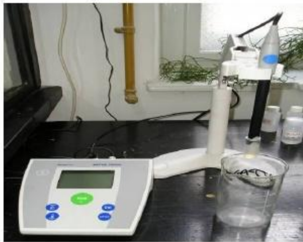
Slika 7. pH-metar S20 SevenEasy 16
