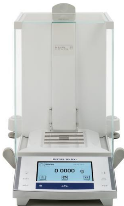
Slika 6. Analitička vaga XS204 DeltaRange, Mettler Toledo 15
