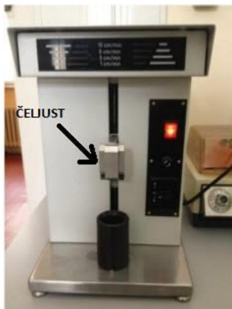
Slika 11. Uređaj za nanošenje prevlaka na predmetna stakalca
