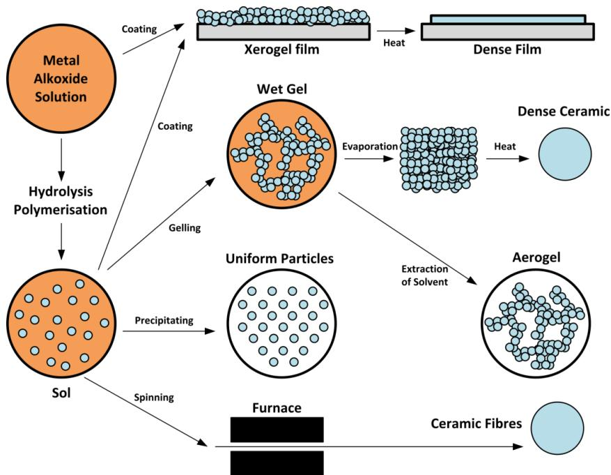
Slika 7. Shematski prikaz dobivanja raznih produkata sol-gel procesom.<sup>25</sup>
