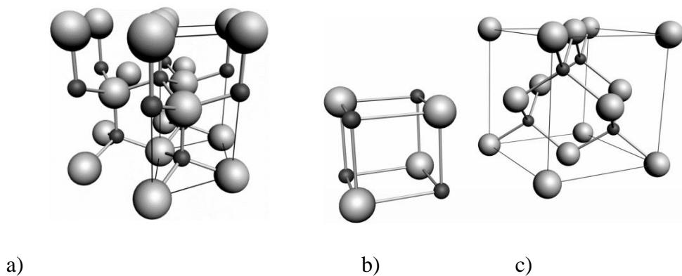
Slika 1. Kristalne strukture ZnO: a) heksagonska vurcitna struktura, b) kubična struktura kamene soli (NaCl) i c) kubična sfaleritna struktura.<sup>5</sup>
