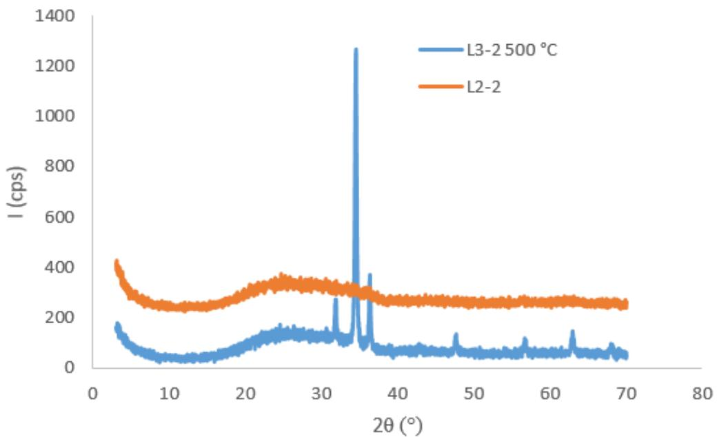
Slika 27. Rendgenogram uzorka L3-2 kalciniranog pri  $500\text{ }^{\circ}\text{C}$  i nekalciniranog uzorka L2-2
