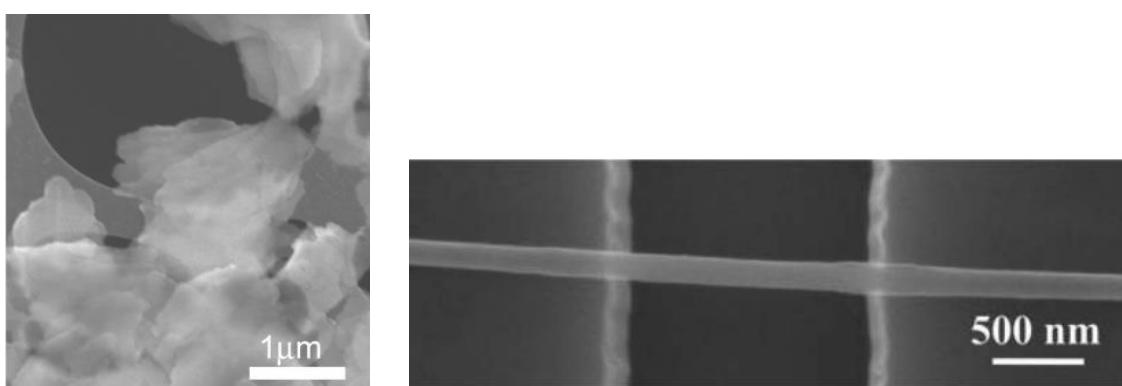
Slika 4. 2D strukture ZnO nanočestica, nanolistovi<sup>11</sup> (lijevo) i nanopojasi<sup>12</sup> (desno)
