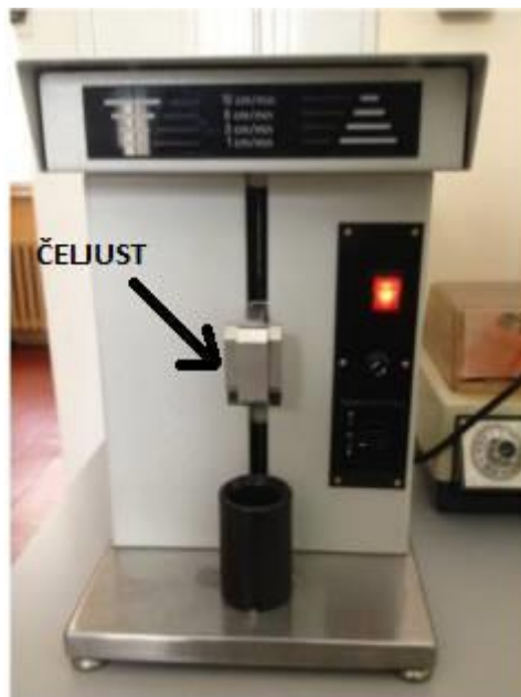
Slika 11. Uređaj za nanošenje prevlaka na predmetna stakalca
