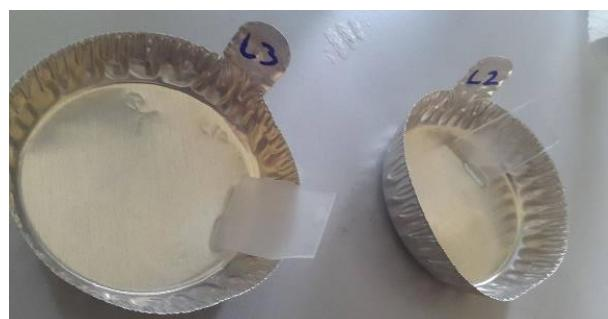
Slika 9. Prikaz staklenih pločica nakon sušenja u sušioniku (110°C)
