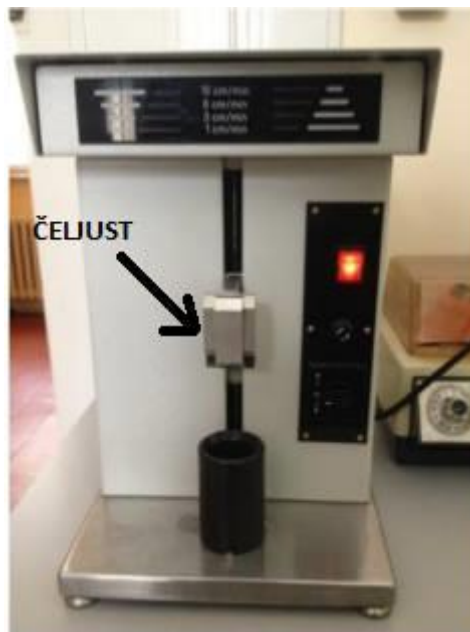
Slika 11. Uređaj za nanošenje prevlaka na predmetna stakalca
