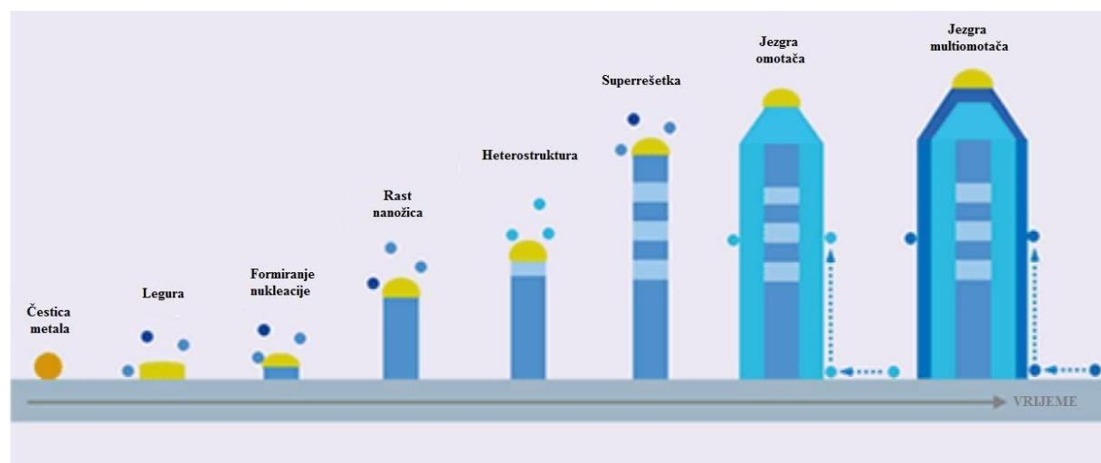
Slika 5. *Bottom-up* tehnika izgradnje nanostruktura<sup>13</sup>
