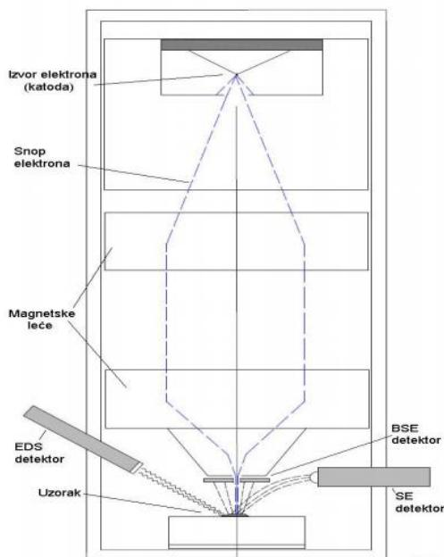
Slika 2. Shema osnovnih elemenata SEM-a<sup>7</sup>
