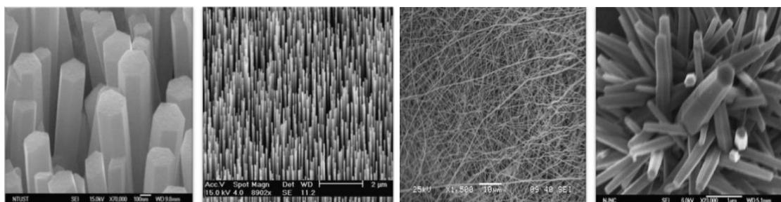
Slika 3. 1D strukture ZnO nanočestica, redom nanožice, nanoštapići, nanocijevi i nanovlakna<sup>10</sup>
