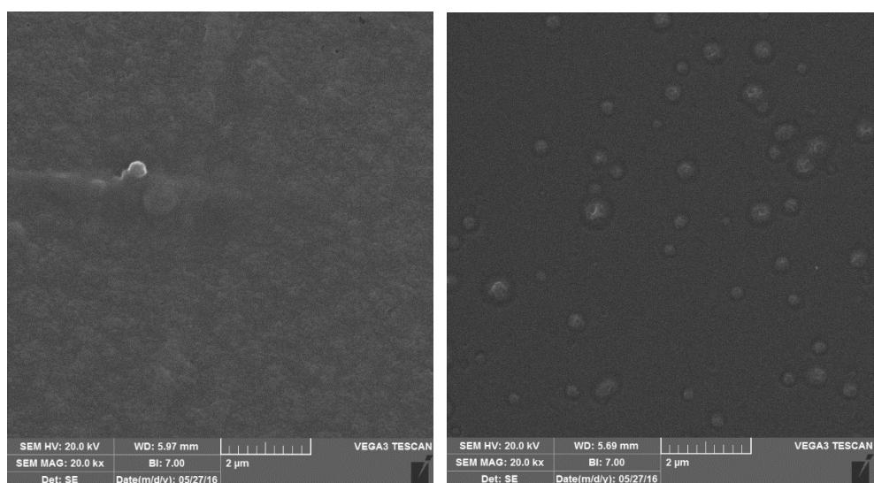
Slika 22. SEM snimka nekalcinirane prevlake s jednom slojem (lijevo) i s deset slojevima (desno)
