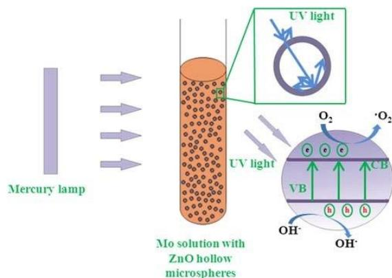
Slika 6. Prijedlog fotokatalitičkog reakcijskog mehanizma šupljih struktura cinkova oksida<sup>15</sup>
