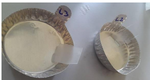
Slika 9. Prikaz staklenih pločica nakon sušenja u sušioniku (110°C)
