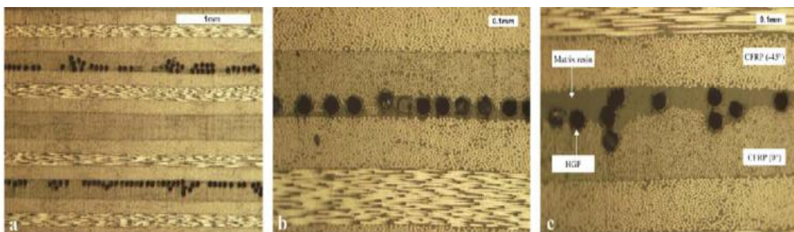
Slika 8. Šuplja vlakna ugrađena u kompozite [33]
