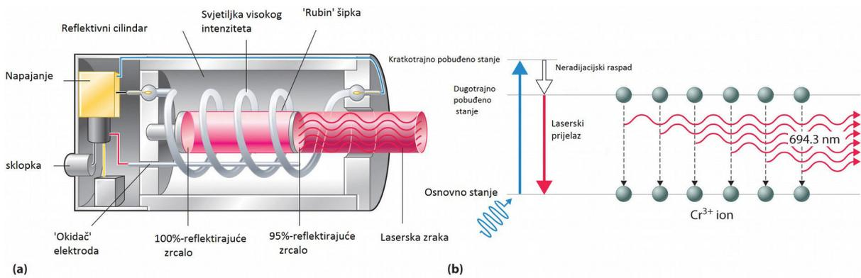
**Slika 18.** Shema lasera s kristalom rubina (a), energetski dijagram (b)
