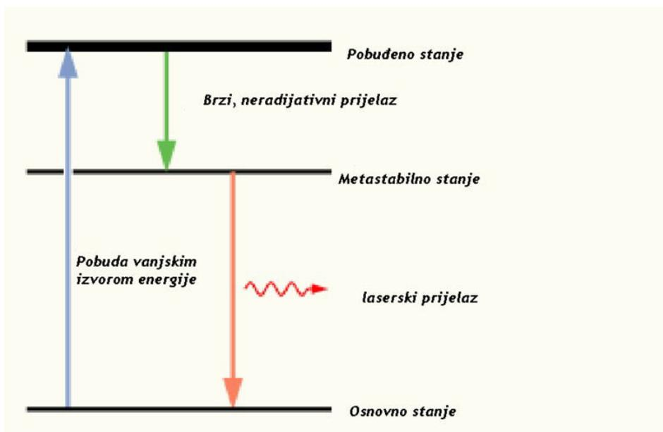
**Slika 17.** Energetski dijagram trostupanjskog lasera
