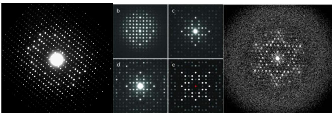
**Slika 21.** Prikaz elektronskog uzorka tantalovog oksida (lijevo), slike elektronske kristalografije na TEM mikroskopu; rezolucija je 1.25 angstroma <sup>5</sup>
