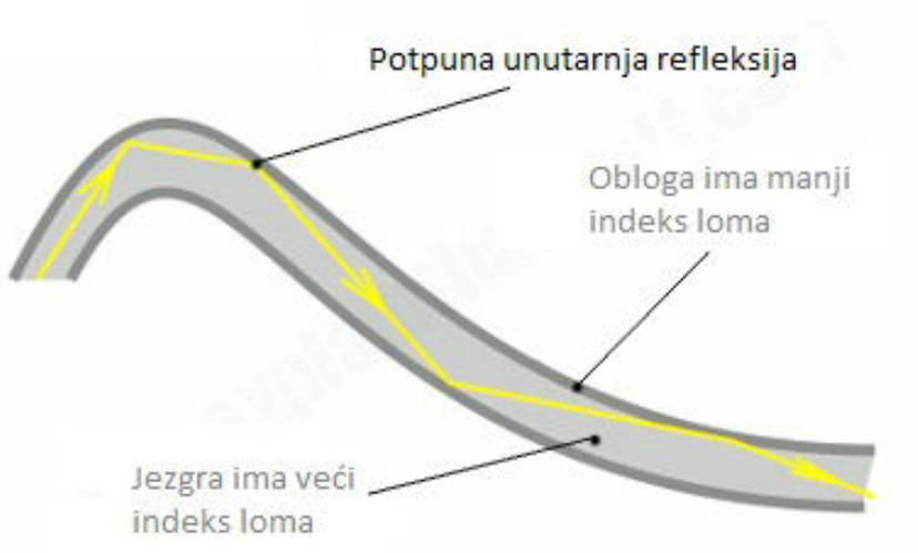
**Slika 19.** Optičko vlakno (svjetlovod)
