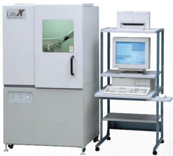
Slika 12. Rendgenski difraktometar, Shimadzu LabX XRD-6000
