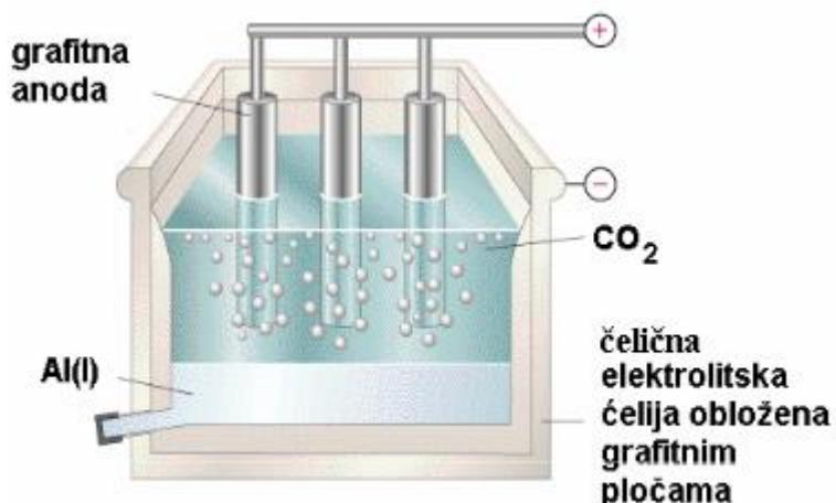
Slika 2. Shematski prikaz ćelije za elektrolitsko dobivanje aluminija. [10]
