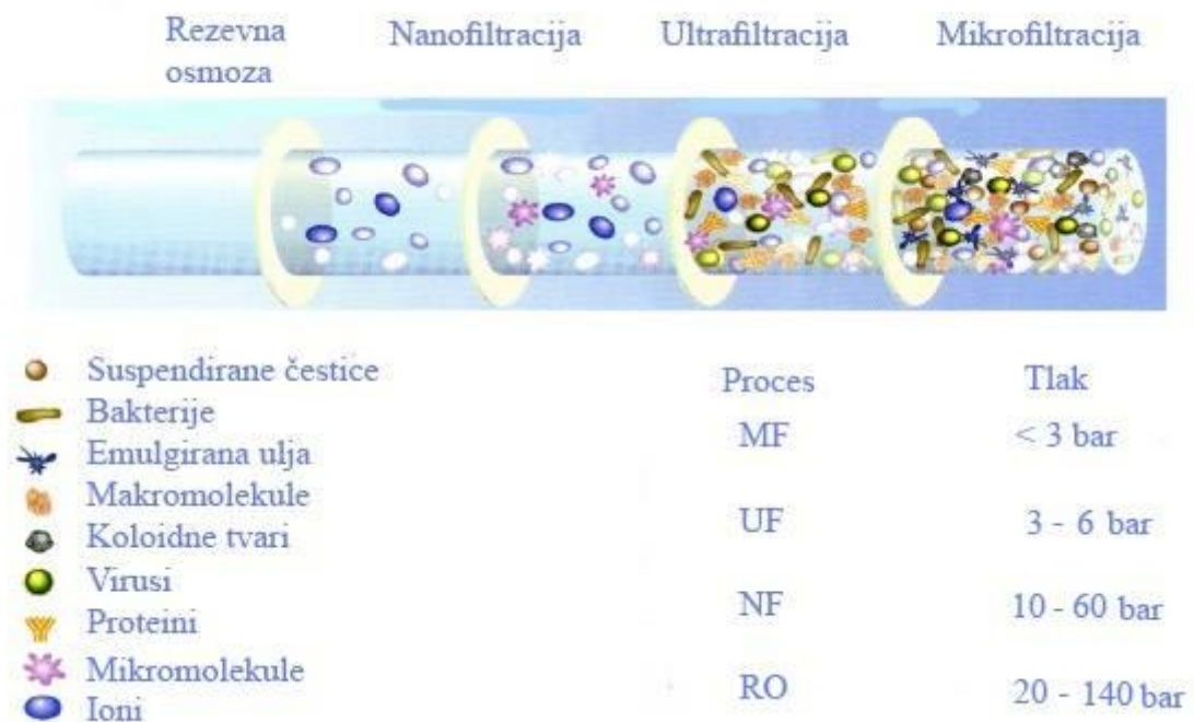
Slika 9. Prikaz mogućnosti uklanjanja pojedinih onečišćenja za različite vrste filtracija [18]
