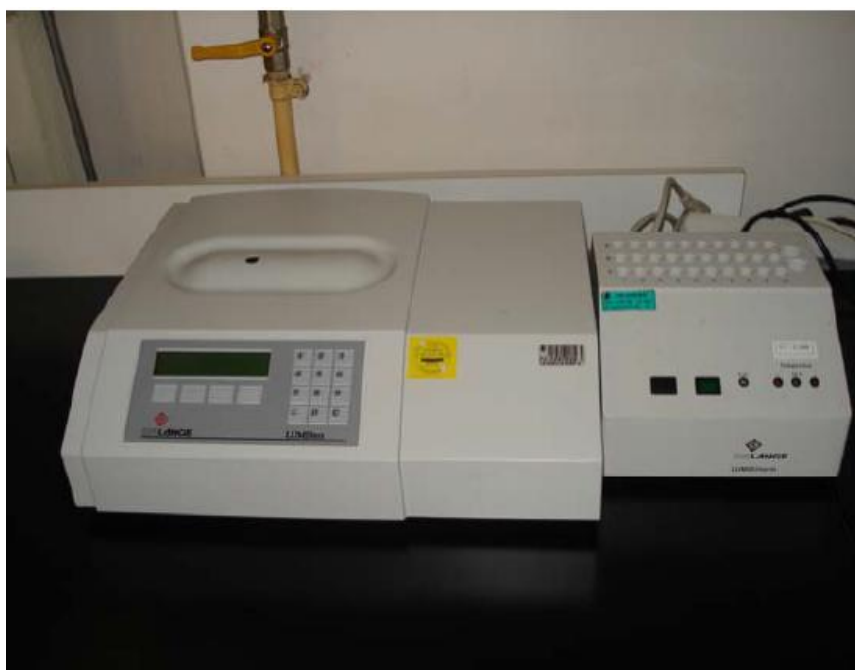
Slika 9. Uređaj za provedbu toksičnosti (LUMIStox 300)
