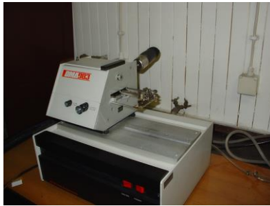
Slika 16. Dinamičko mehanički analizator 983,TAInstruments
