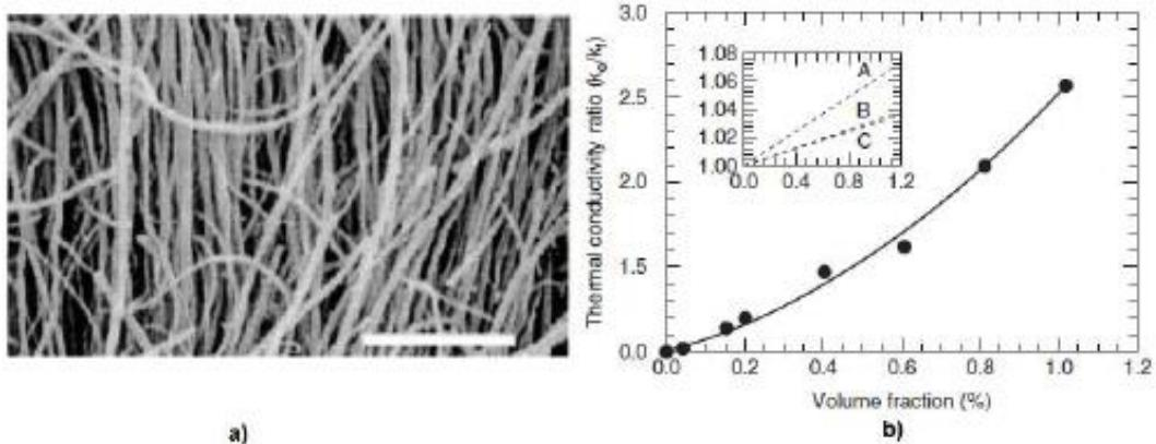
Slika 2.4.1. Prikaz: a) SE mikrografija MWCNT-a, b) Rezultati istraživanja toplinske vodljivosti nanofluida na osnovi MWCNT (Choi i suradnici)<sup>15</sup>
