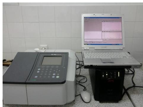
Slika 2. Spektrofotometar, Shimadzu - UV 1800
