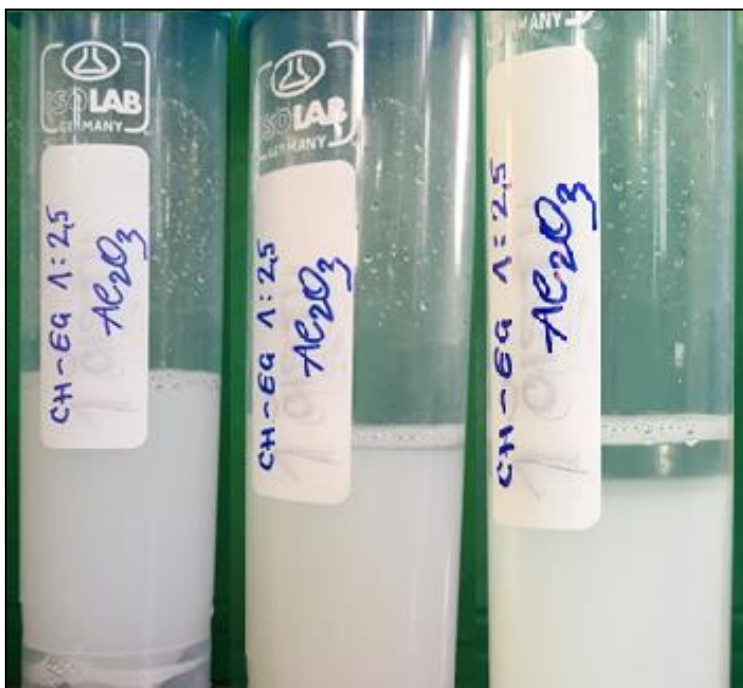
Slika 12. Praćenje stabilnosti suspenzije ChCl:EG s nanočesticama \text{Al}_2\text{O}_3 (0,3vol%) na dan pripreme, prvo jasno uočavanje taloga i osmi dan nakon uočavanja taloga
