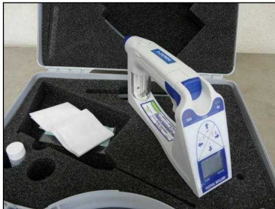
Slika 11. Uređaj za mjerenje gustoće kapljevine METTLER TOLEDO Densito 30PX
