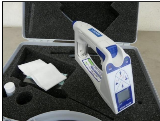
Slika 11. Uređaj za mjerenje gustoće kapljevine METTLER TOLEDO Densito 30PX
