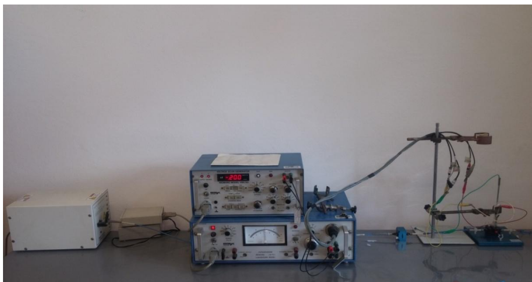
Slika 3.4. Aparatura za UV/VIS spektroskopiju sa potenciostatom
