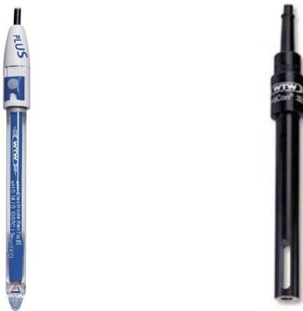
Slika 12. a) pH elektroda *SenTix 81*, b) konduktometrijska elektroda *WTW Tetracon 325*
