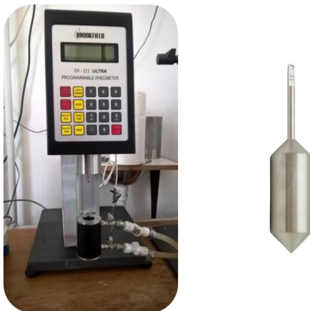
Slika 11. a) Rotacijski viskozimetar Brookfield DV – III ULTRA , b) vreteno SC4-21
