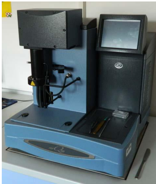
Slika 3.4.1. Termogravimetar TA Instruments Q500
