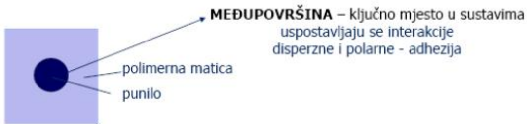
Slika 18. Prikaz međupovršine matica - punilo
