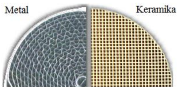
Slika 2.1. Metalni i keramički monolitni supstrat/nosač 6
