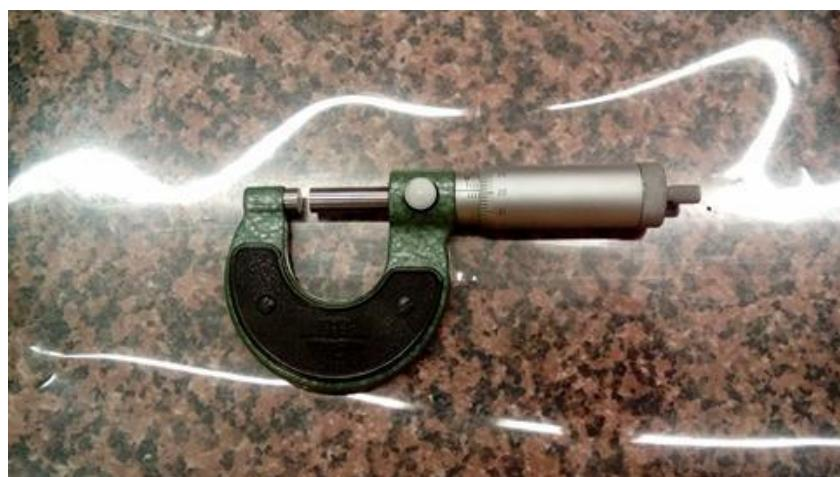
**Slika 3.9.** Uređaj za određivanje debljine listova
