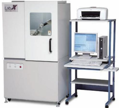
**Slika 3.7.** Rendgenski difraktometar Shimadzu XRD-600
