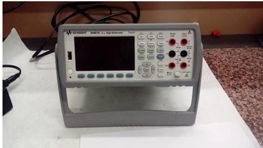
**Slika 3.8.** Uređaj za mjerenje električnog otpora *Keysight 34461 6<sub>1/2</sub> Digit Multimeter*
