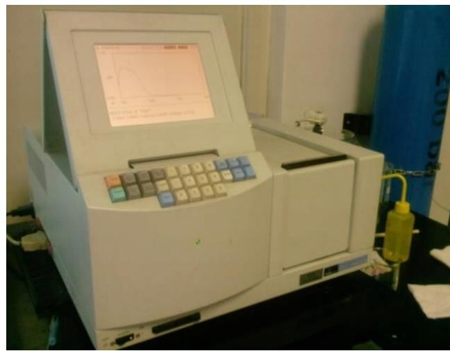
**Slika 3.10.** UV/Vis spektrofotometar Perkin Elmer Lambda EZ 201
