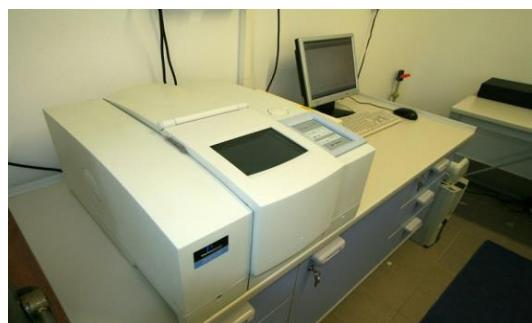
**Slika 3.5.** FTIR spektrofotometar Perkin Elmer Spectrum One
