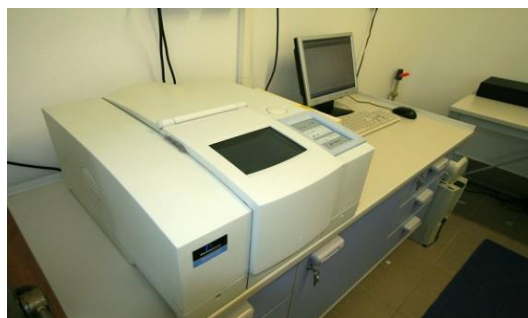
Slika 3.5. FTIR spektrofotometar Perkin Elmer Spectrum One
