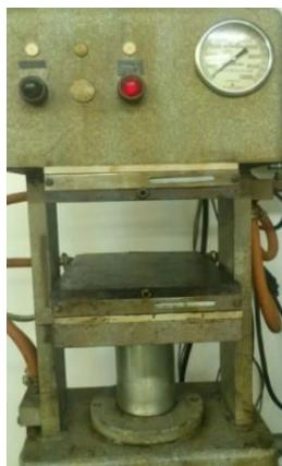
**Slika 11.** Hidraulička preša Dake Model 44-226
