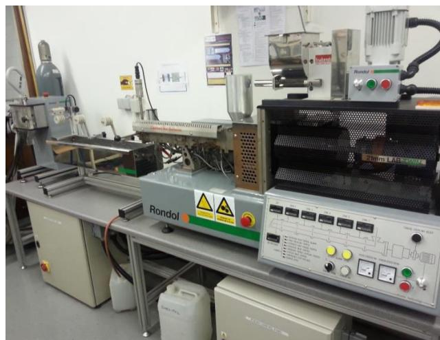
**Slika 10.** Rondol 21mm LAB TWIN ekstruder
