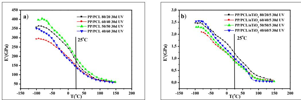
**Slika 21.** Krivulje modula pohrane u ovisnosti o temperaturi za PP/PCL mješavine bez dodatka i s dodatkom nTiO<sub>2</sub> nakon UV zračenja.
