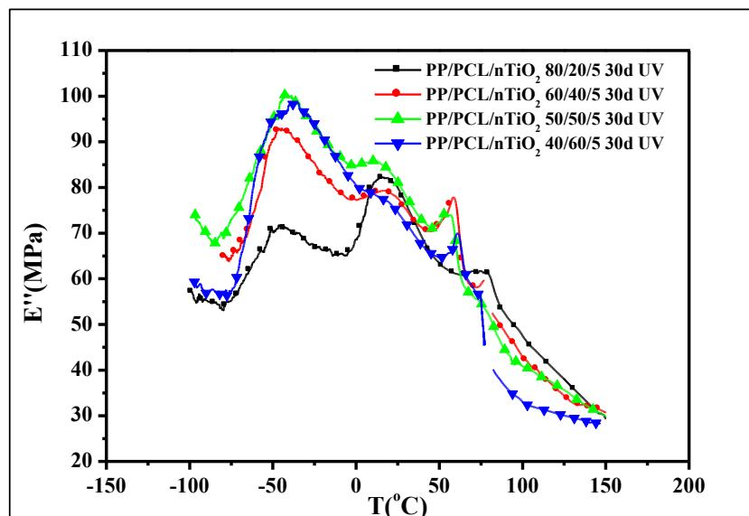
**Slika 19.** Krivulje modula gubitka u ovisnosti o temperaturi za PP/PCL mješavine s dodatkom nTiO<sub>2</sub> nakon UV zračenja.
