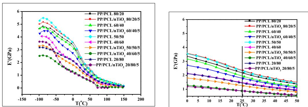
**Slika 20.** Krivulje modula pohrane u ovisnosti o temperaturi za PP/PCL mješavine s dodatkom nTiO<sub>2</sub> prije UV zračenja (slika lijevo E'/T temperaturni interval od -150 do 200°C; slika desno E'/T temperaturni interval od 0 do 50°C).
