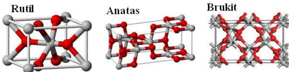
Slika 9. Kristalne strukture  $\text{TiO}_2$  <sup>[12]</sup>
