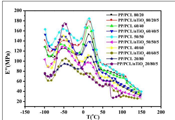
**Slika 17.** Krivulje modula gubitka u ovisnosti o temperaturi za PP/PCL mješavine s dodatkom nTiO<sub>2</sub>
