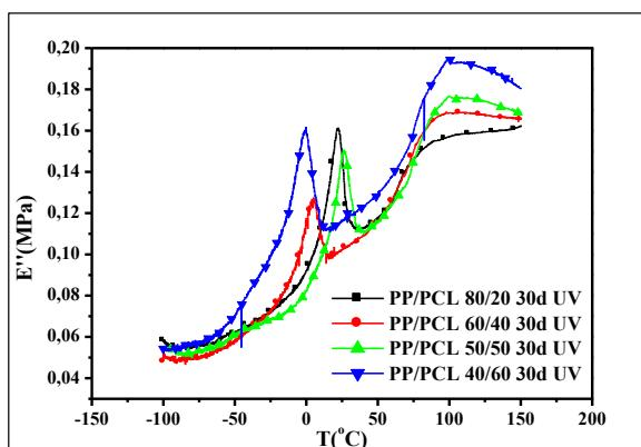
**Slika 18.** Krivulje modula gubitka u ovisnosti o temperaturi za PP/PCL mješavine bez dodatka nTiO<sub>2</sub> nakon UV zračenja.
