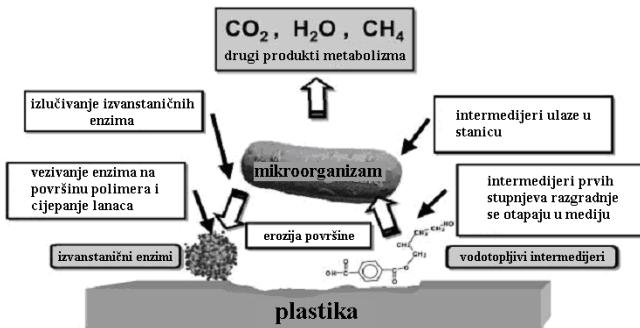
**Slika 2.** Biorazgradnja polimera uz pomoć mikroorganizama[6].
