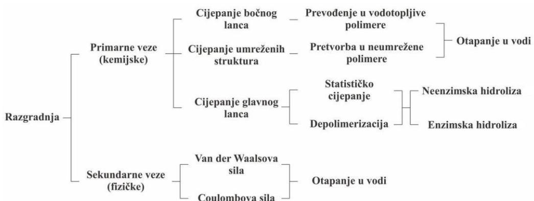
**Slika 3.** Mehanizmi razgradnje polimera
