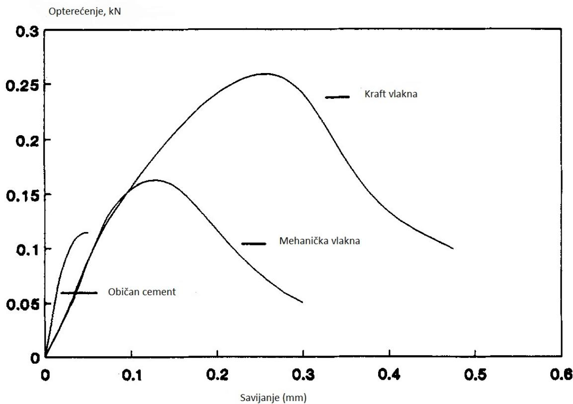
Slika 8. Krivulja savijanja, opterećenje – otklon [4]
