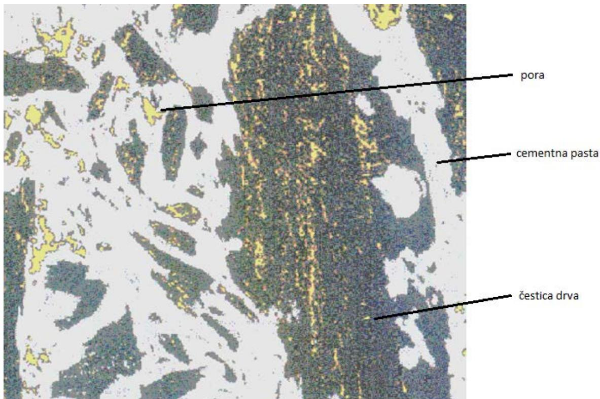
Slika 2. Struktura drvo – cementnog kompozita [10]
