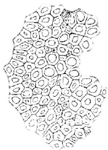
Slika 3. Poprečni presjek sisal vlakna [11]
