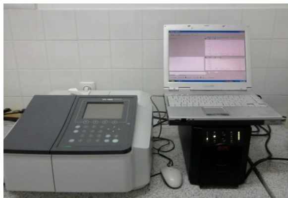
Slika 10. Spektrofotometar Shimadzu UV-1800
