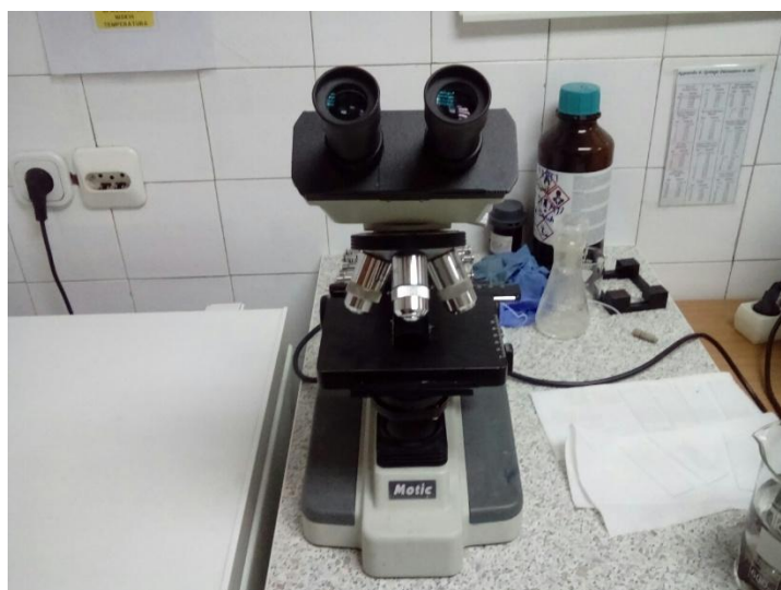
Slika 12. Optički mikroskop Motic B1-220A
