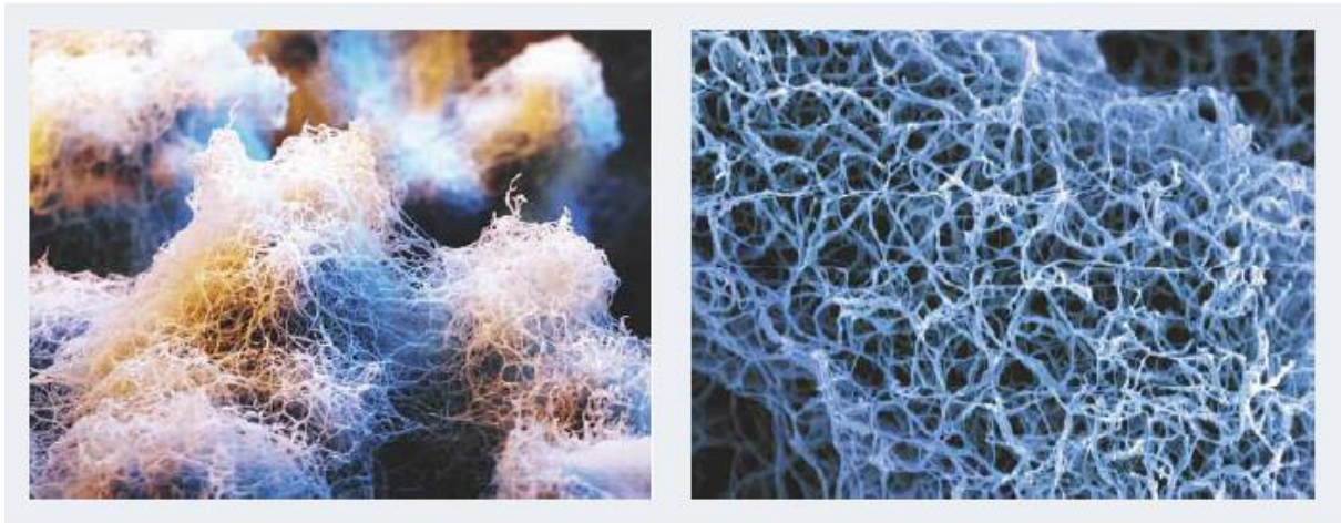
Slika 4. Nanoporozna polimerna pjena (desna slika, povećanje pomoću elektronskog mikroskopa) koja ima veliki potencijal u toplinskoj izolaciji [44]
