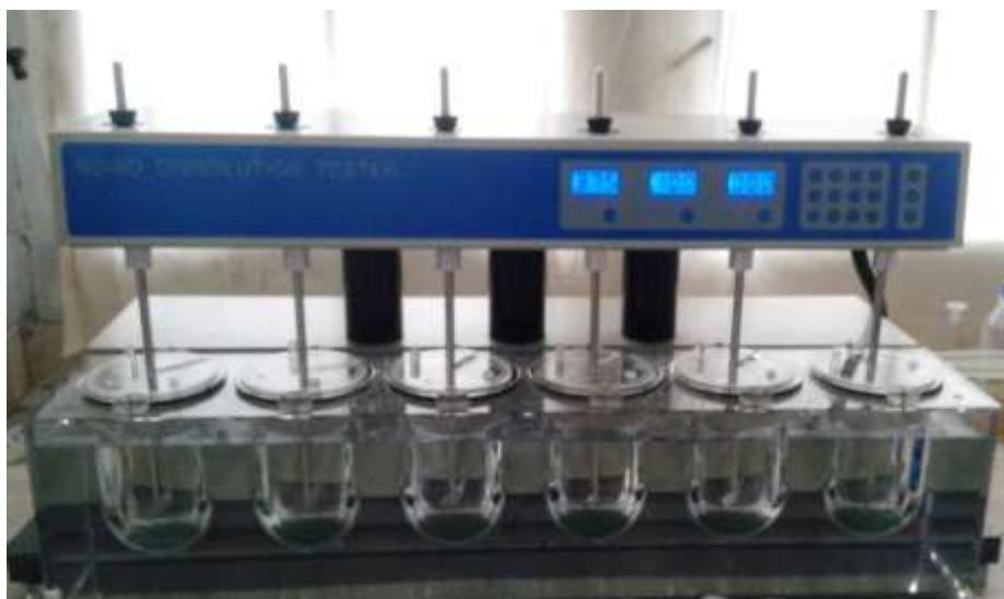
**Slika 3. 3.** Uređaj za ispitivanje brzine otpuštanja djelatne tvari RC-6D, Zhengzhou Nanbei
