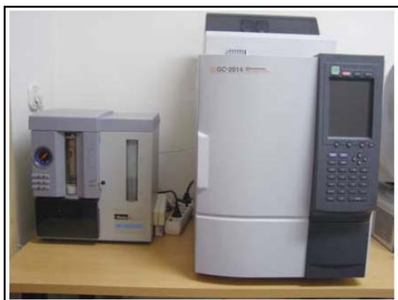
Slika 3.2. Plinski kromatograf Shimadzu GC – 2014 i Parker 9150 generator vodika
