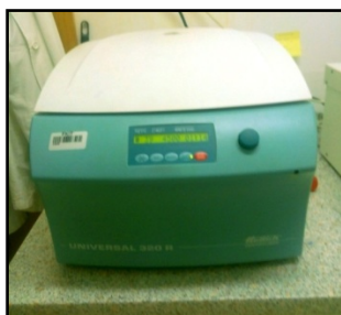
Slika 3.3. Centrifuga Hettich Universal 320R
