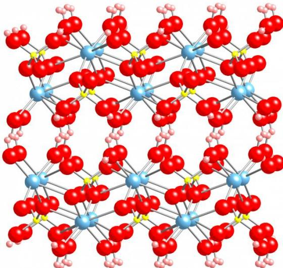
Slika 2. Struktura  $\text{CaSO}_4 \times 2\text{H}_2\text{O}$  (Ca - plavo, S - žuto, O - crveno, H - rozo)<sup>[3]</sup>
