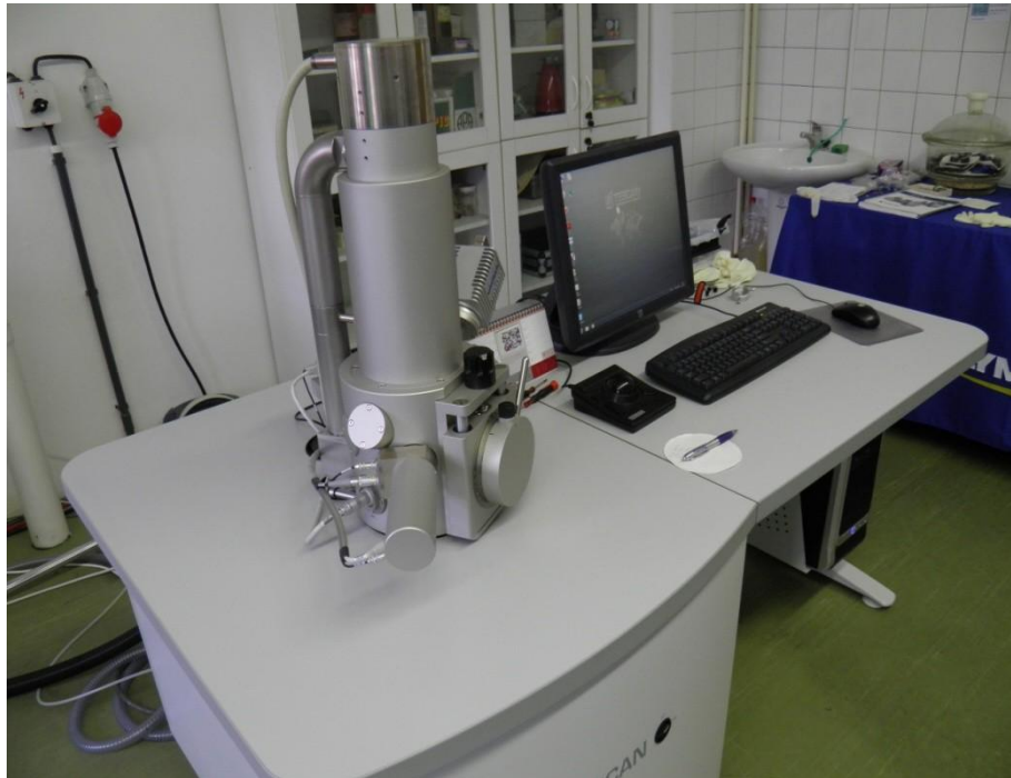
Slika 13. Skenirajući elektronski mikroskop [11]
