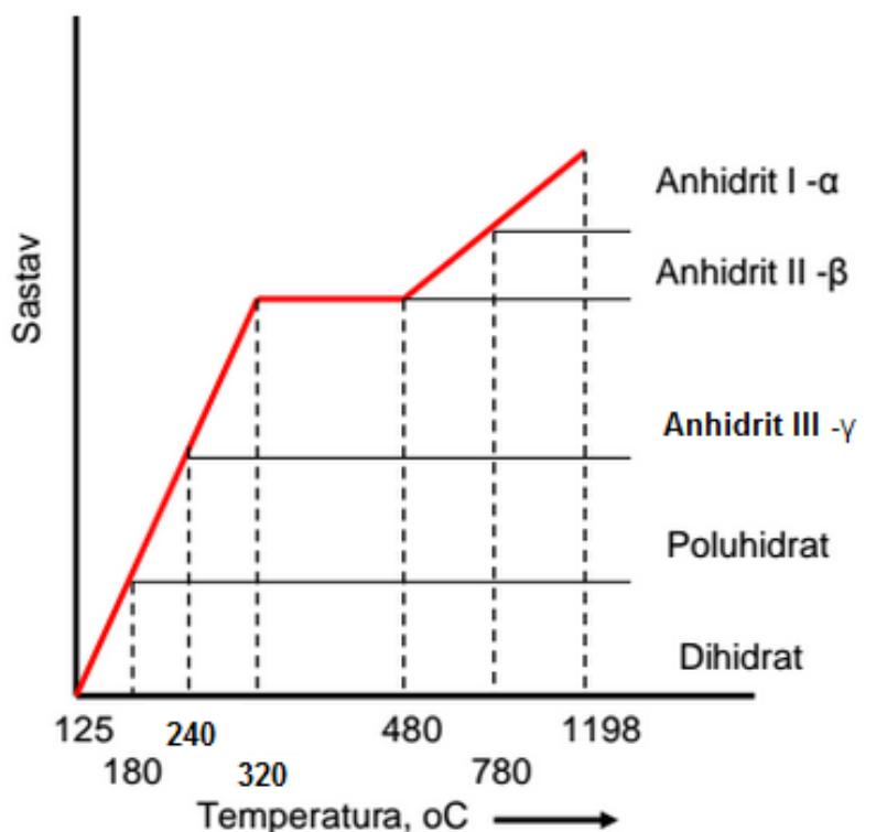
**Slika 7.** Strukturne transformacije u ovisnosti o temperaturi <sup>[8]</sup>
