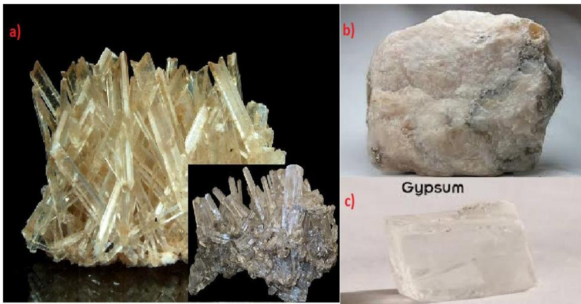
**Slika 3.** Različiti oblici gipsa:<sup>[6]</sup> a) sulfatni mineral kristaliziran u monoklinskom sustavu
