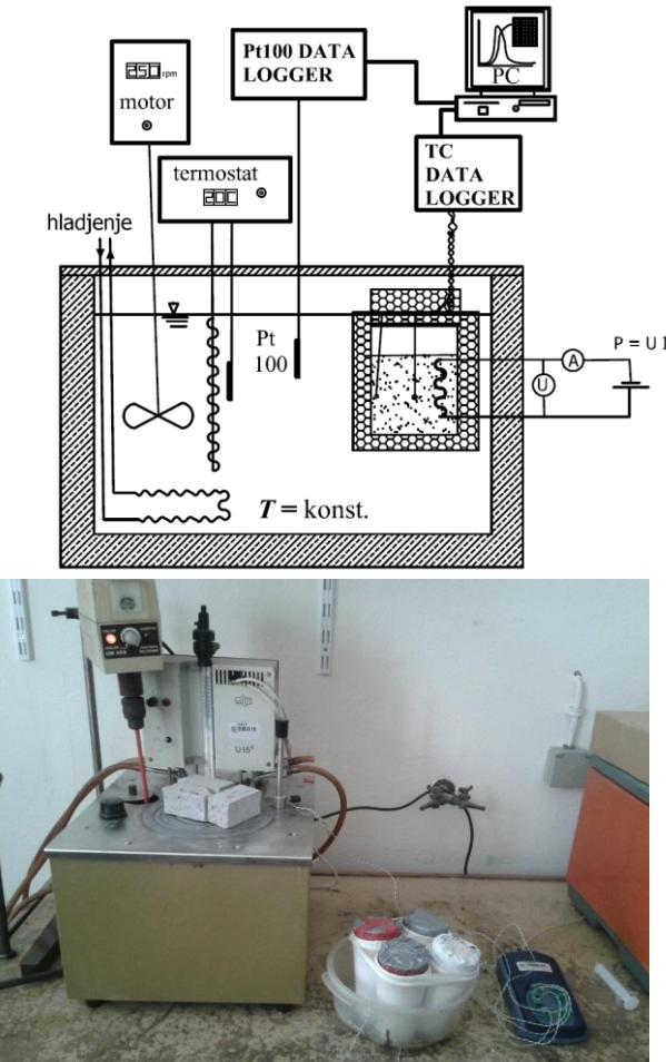
**Slika 17.**Pojednostavljeni prikazi eksperimentalnog postava semi-adijabatskog kalorimetra.
