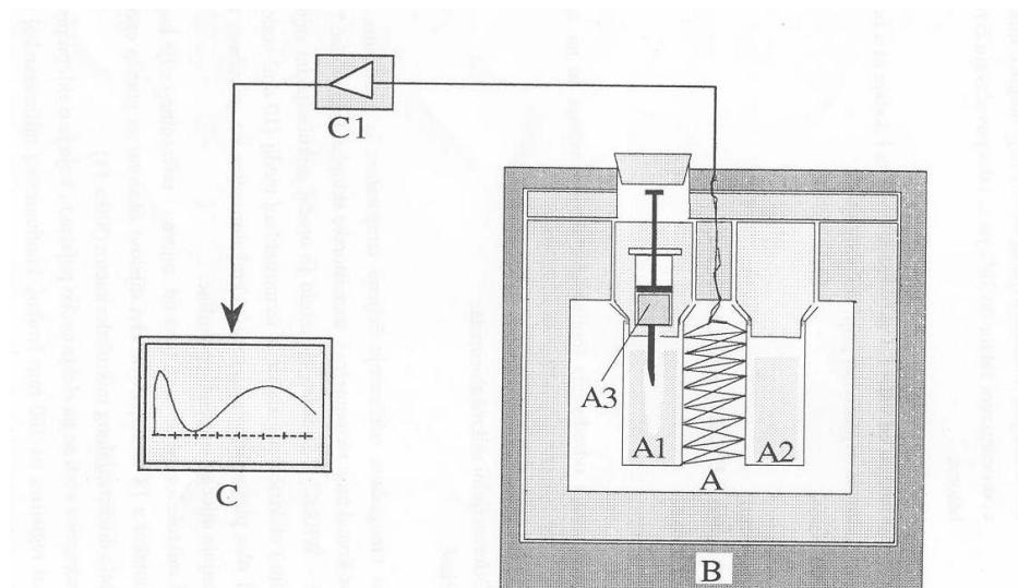
**Slika 14.** Pojednostavljeni prikaz aparature za određivanje topline hidratacije pomoću diferencijalnog mikrokalorimetra. A – diferencijalni mikrokalorimetar, B – termostat, C – računalo, A1 – merna ćelija, A2 – referentna ćelija, A3 – medicinska šprica s vodom, C1 – elektronički uređaj za prikupljanje signala termoparova<sup>[13]</sup>
