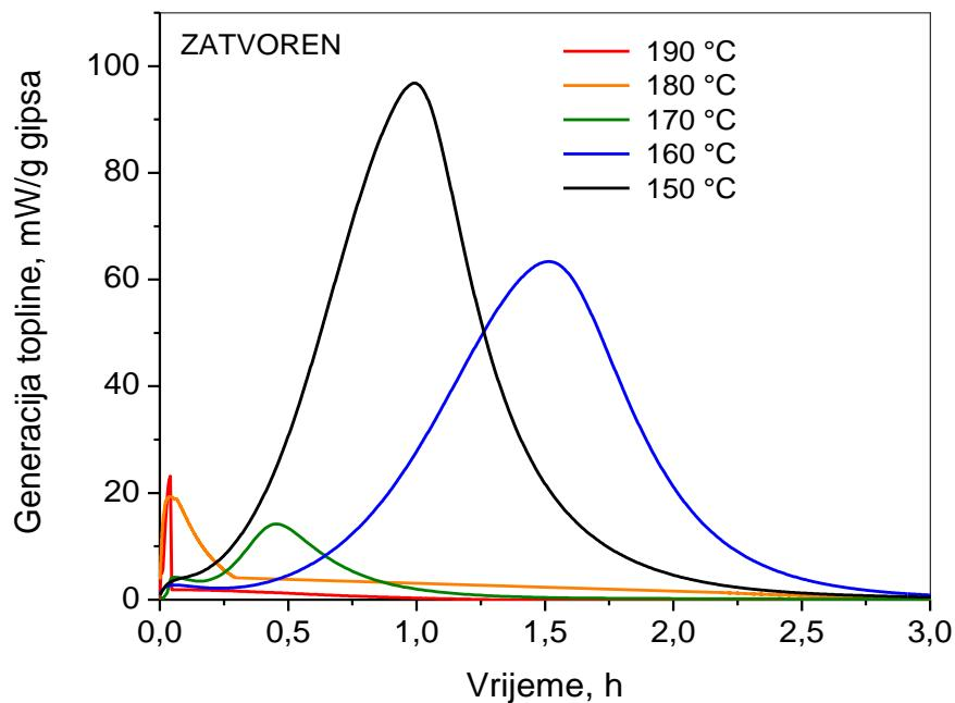
**Slika 34.** Rezultati mikrokalorimetrijskog mjerjenja topline hidratacije uzorka gipsa pripravljenih u zatvorenom sustavu pri temperaturama od 150-190 °C.
