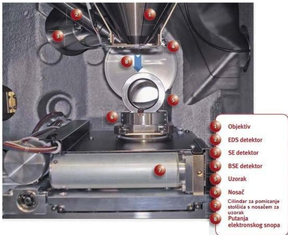
Slika 12. Unutrašnjost komore SEM-a za uzorke<sup>[11]</sup>
