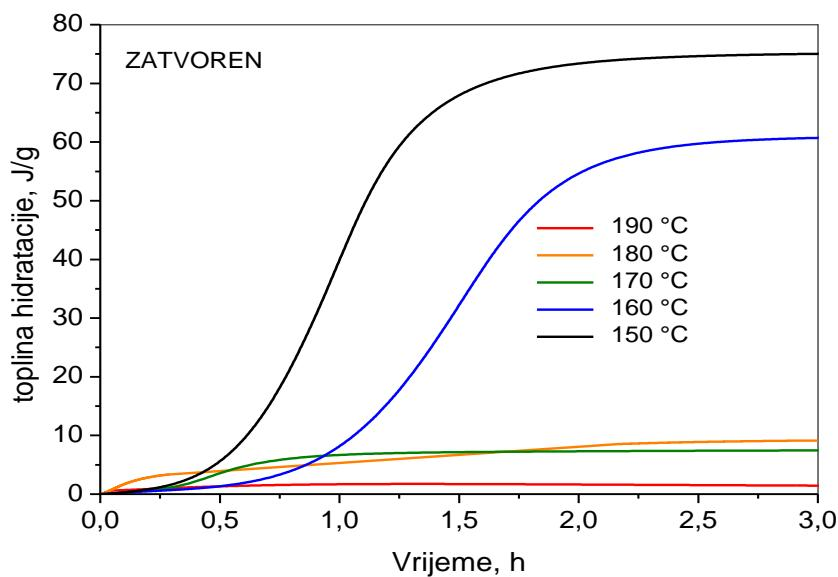
**Slika 35.** Integralna toplina hidratacije uzorka gipsa pripravljenih u zatvorenom sustavu pri temperaturama od 150-190 °C.
