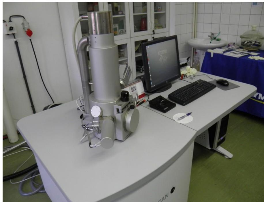
**Slika 13.**Skenirajući elektronski mikroskop <sup>[11]</sup>
