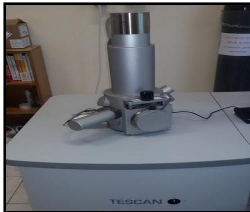
**Slika 24.** Elektronski mikroskop SEM-TESCAN VEGA TS5236LS
