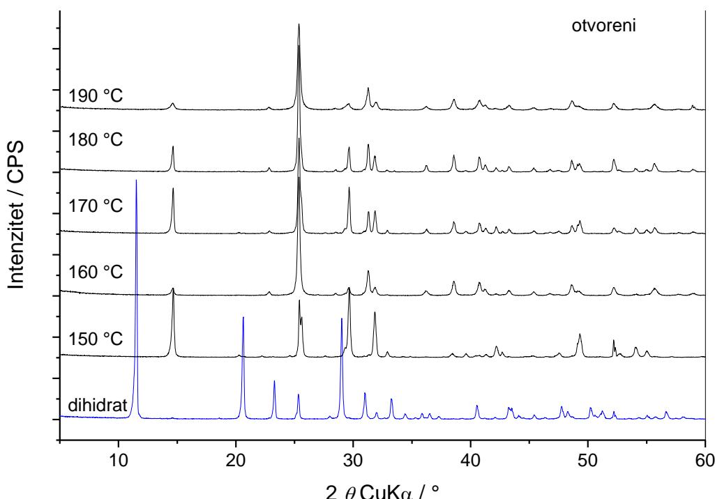
**Slika 28.** Rezultati rendgenske difrakcijske analize otpadnog gipsa (plavo) i produkata termičke obrade otpadnog gipsa u laboratorijskom autoklavu otvorenom prema atmosferi pri temperaturama od 150, 160, 170, 180 i 190 °C.
