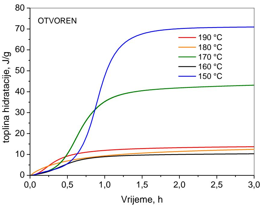
**Slika 37.** Integralna toplina hidratacije uzorka gipsa pripravljenih u otvorenom sustavu pri temperaturama od 150-190 °C.
