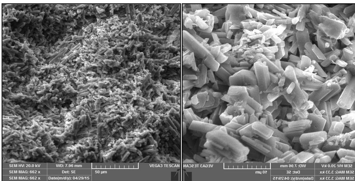
**Slika 33.** Rezultati elektronske mikroskopije uzorka otpadnog gipsa, 130 °C, zatvoreni sustav
