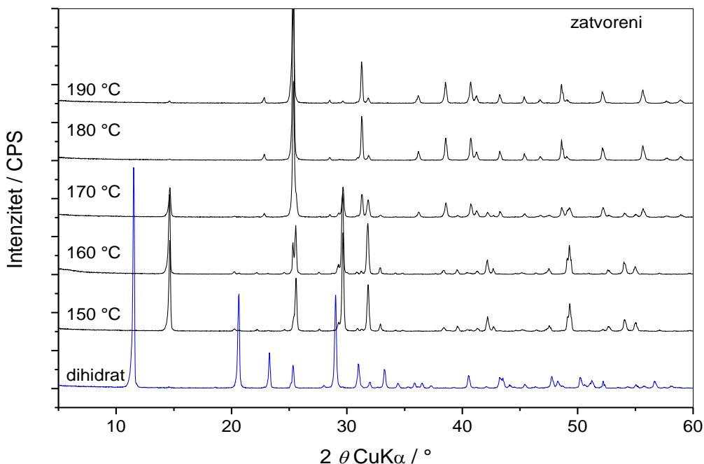
**Slika 29.** Rezultati rendgenske difrakcijske analize otpadnog gipsa (plavo) i produkata termičke obrade otpadnog gipsa u laboratorijskom autoklavu *zatvorenom* prema atmosferi pri temperaturama od 150, 160, 170, 180 i 190 °C.
