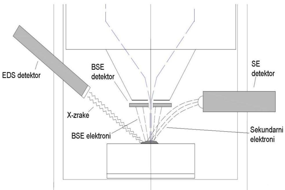
**Slika 11.**Prikaz tri osnovna tipa detektora<sup>[11]</sup>
