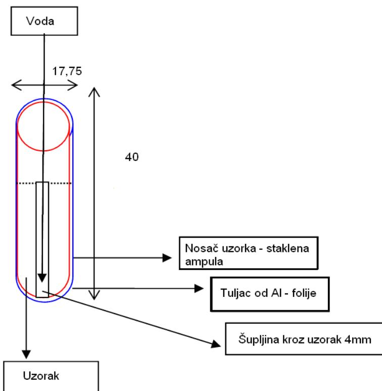
**Slika 16.** Nacrt mjerne čelije za mikrokalorimetriju (mjere u mm).
