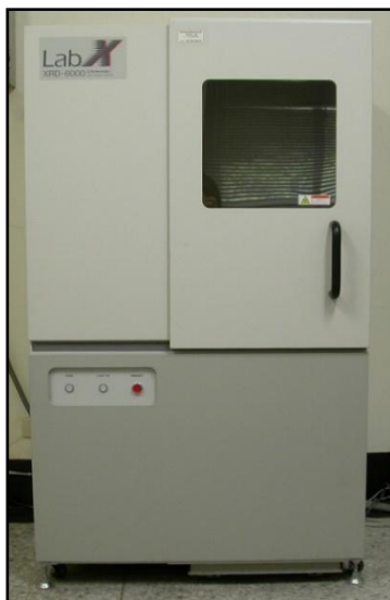
Slika 23. Uređaj za rendgensku difrakcijsku analizu
