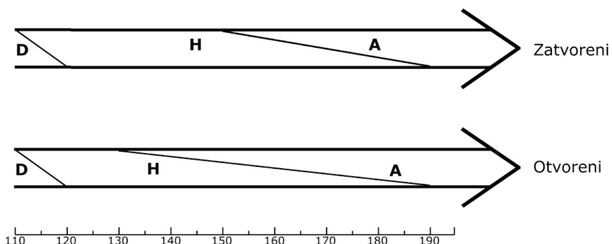
**Slika 30.** Prijelaz iz dihidrata (**D**) u hemihidrat (**H**) i anhidrit (**A**), prikazan shematski na temelju rezultata eksperimenta termičke obrade otpadnog gipsa u autoklavu otvorenom i zatvorenom prema atmosferi.
