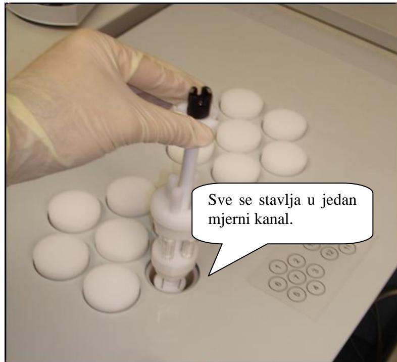
**Slika 27.** Umetanje MC CAL u mjerni kanal
