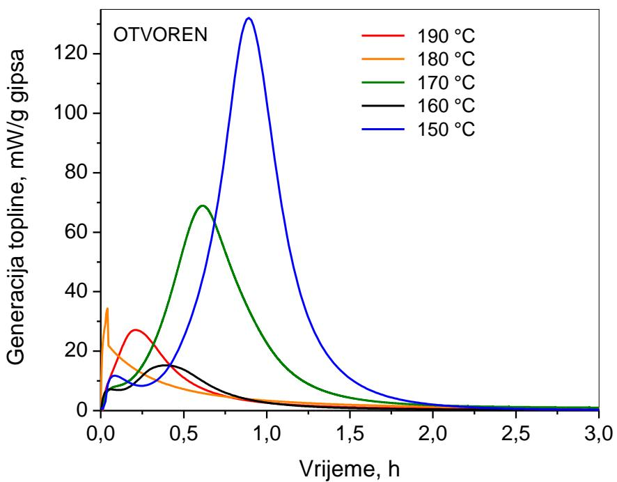
**Slika 36.** Rezultati mikrokalorimetrijskog mjerjenja topline hidratacije uzorka gipsa pripravljenih u otvorenom sustavu pri temperaturama od 150-190 °C.
