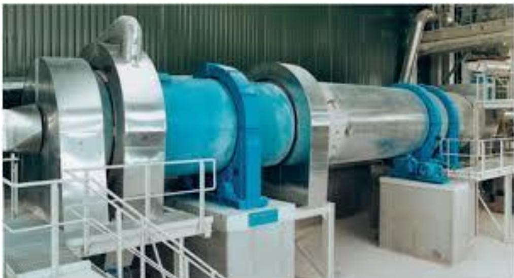
Slika 6. Rotacijski kalcinator gipsa<sup>[5]</sup>
