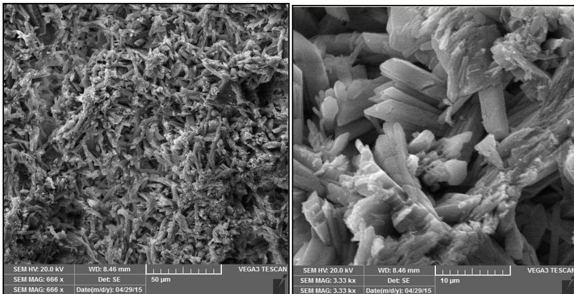
**Slika 32.** Rezultati elektronske mikroskopije uzorka otpadnog gipsa, 130 °C, otvoreni sustav
