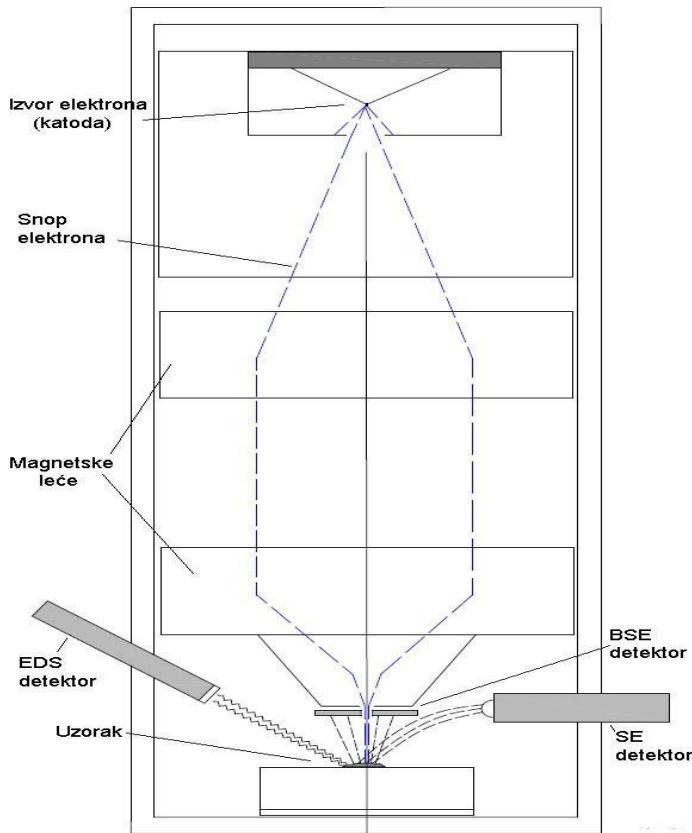
**Slika 10.** Shema osnovnih elemenata SEM-a<sup>[11]</sup>
